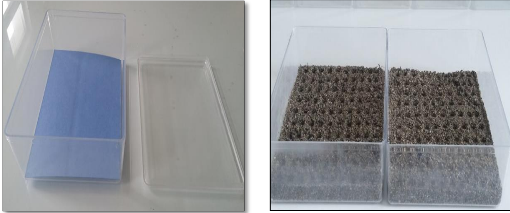
Şekil 3.3. Çimlendirme test kabı, çimlendirme kağıdı ve çıkış testi için kullanılan kum materyalinin görünüşleri
