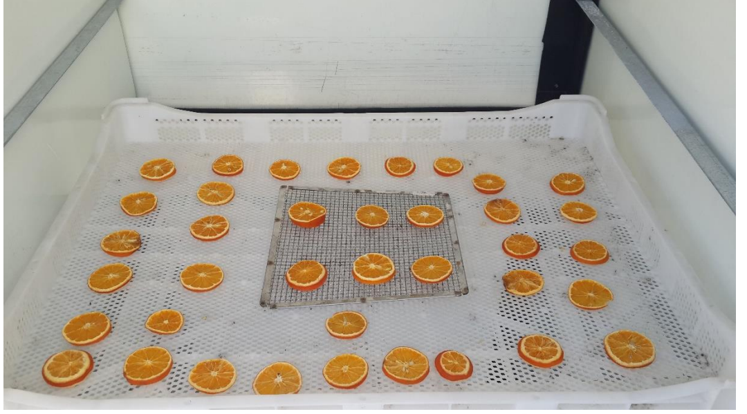
Şekil 6.42 Kurutma kabinde kurutulan portakal dilimlerin görünüşü (Birinci grup numuneler).
