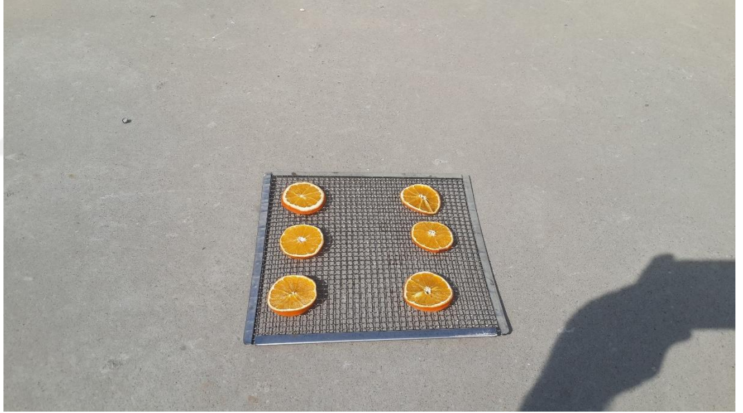
Şekil 6.51 Kurutulmak üzere açık havada güneşe bırakılan portakal dilimleri (İkinci grup kurutma deneyi).
