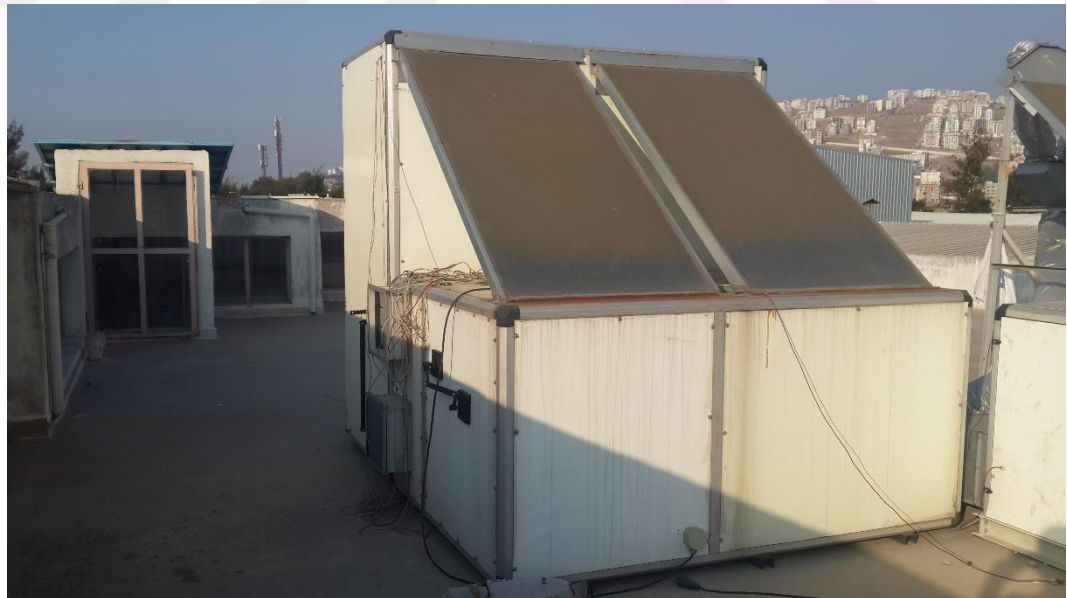
Şekil 5.6 Güneş enerjisi destekli kurutucunun önden görünüşü.
