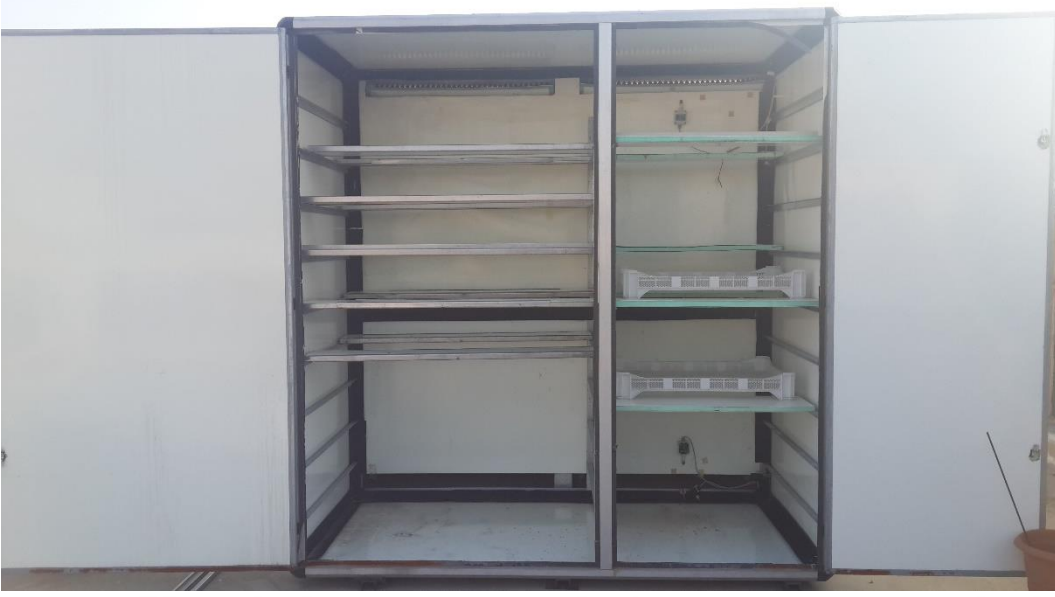
Şekil 5.7 Güneş enerjisi destekli kurutucunun arkadan kapakları açık bir şekilde görünüşü.
