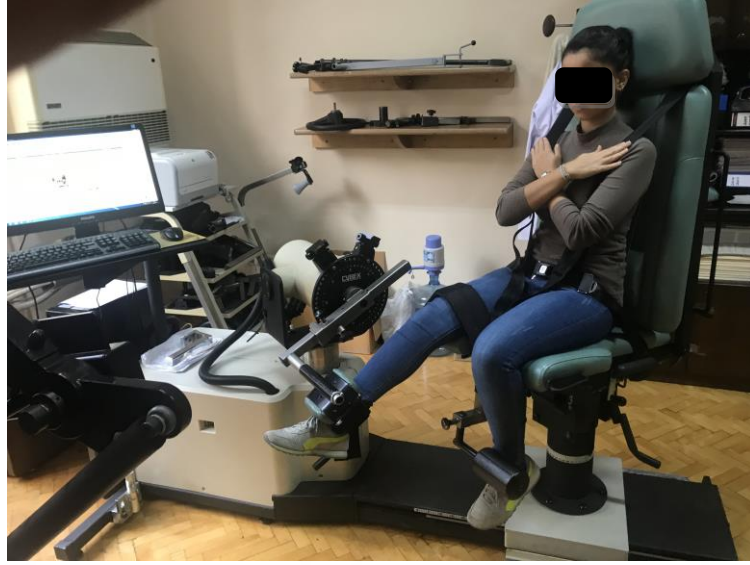
Şekil 3-4: İzokinetik dinamometre ile proprioepsiyon ölçümü
