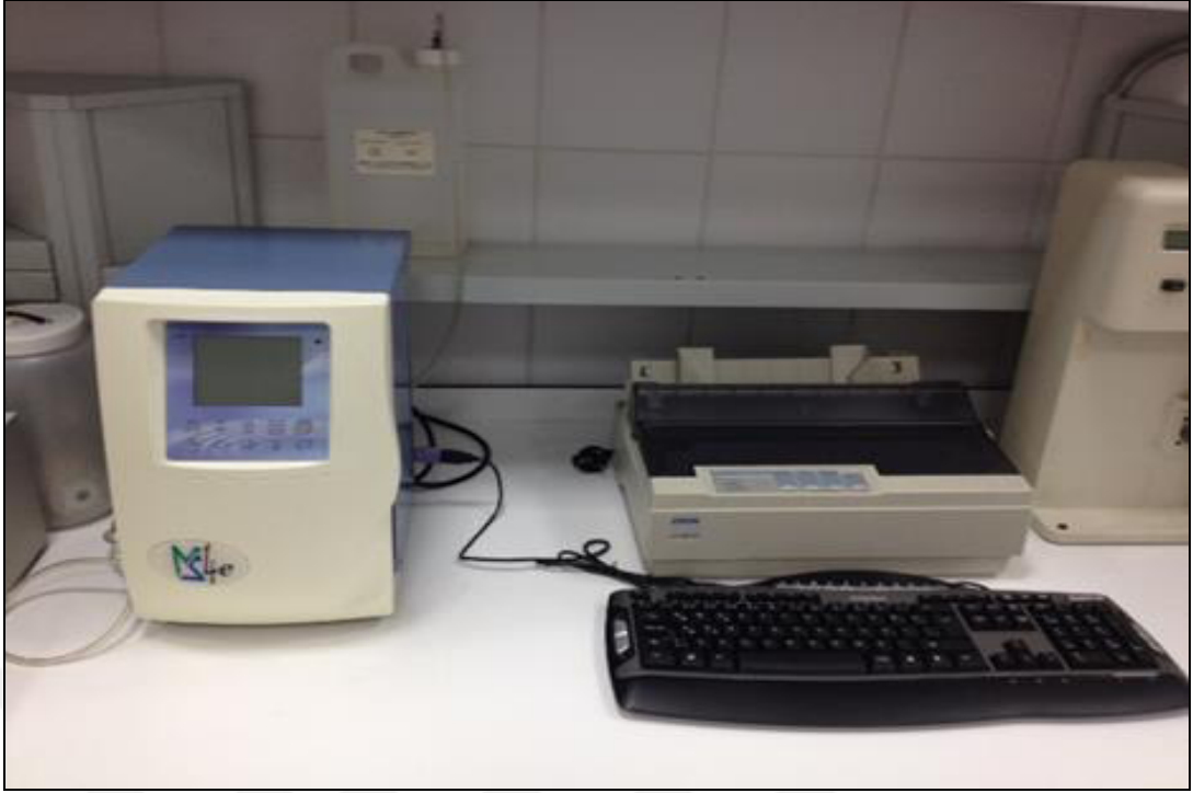
Şekil 3.4. Hematolojik analizlerde kullanılan tam kan cihazı (Ms4 Melet Schloesing)
