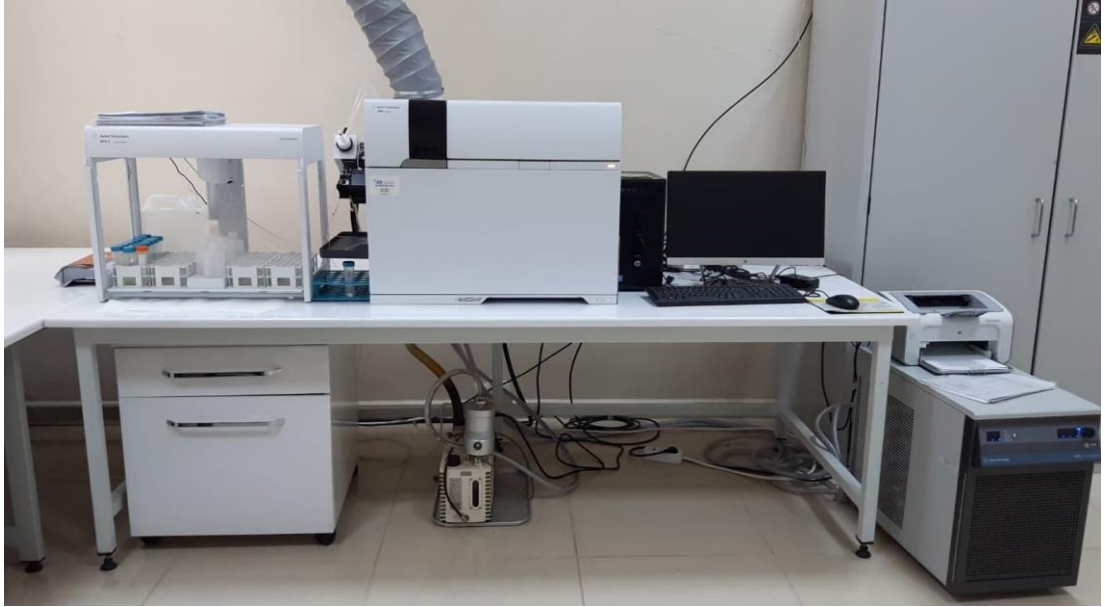
Şekil 3.6. Mikro element ve ağır metal (B, Fe, Mn, Zn, Cu, Ni, Pb ve Cd) içeriklerinin ICP-MS'de ölçümleri
