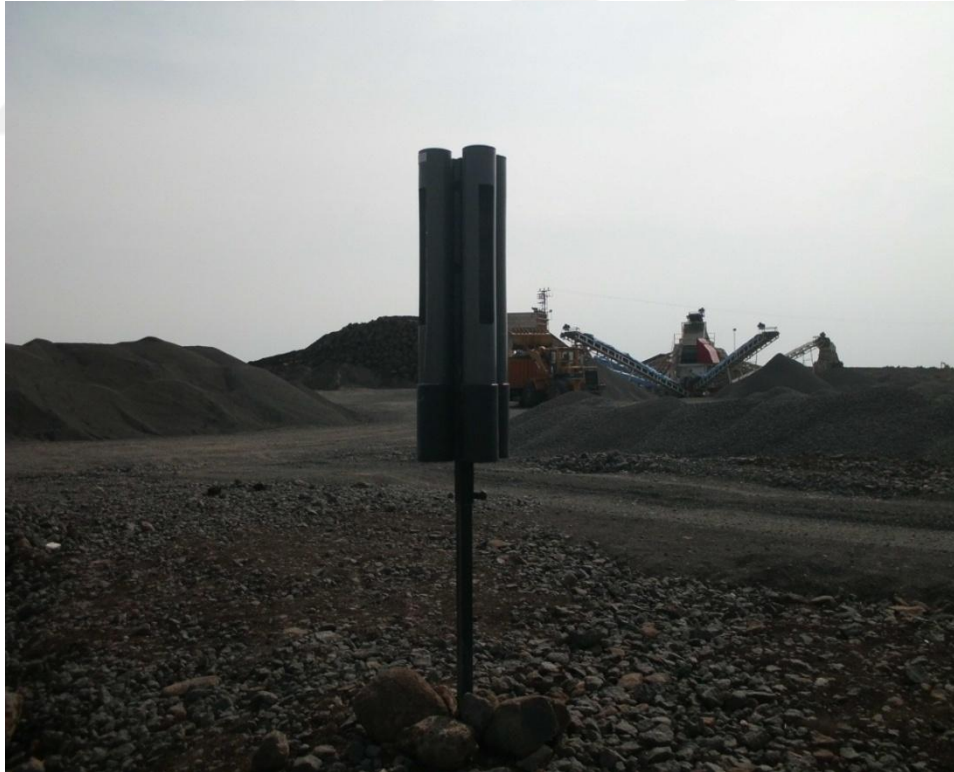
Şekil 3.6. TSE 2342 standardına göre çöken toz aparatı
