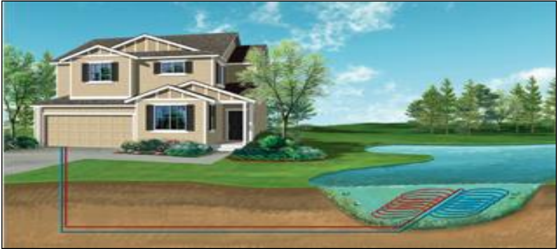
Şekil 1.13. Yüzey Suyu Kapalı Isı Pompası Sistemi( http://www.maxen.com.tr )
