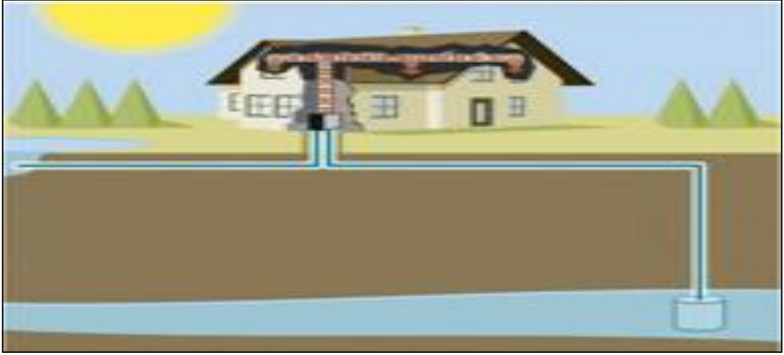
Şekil 1.12. Yüzey Suyu Açık Isı Pompası Sistemi( http://www.maxen.com.tr )
