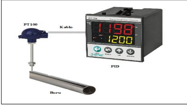
Şekil 3.28. PT100 Sensörlü Sıcaklık Kontrol Sistemi
