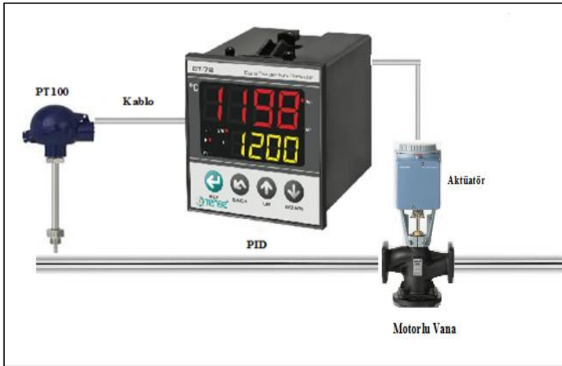
Şekil 3.29. Sıcaklık Kontrol Sistemine Motorlu Vananın Takılması
