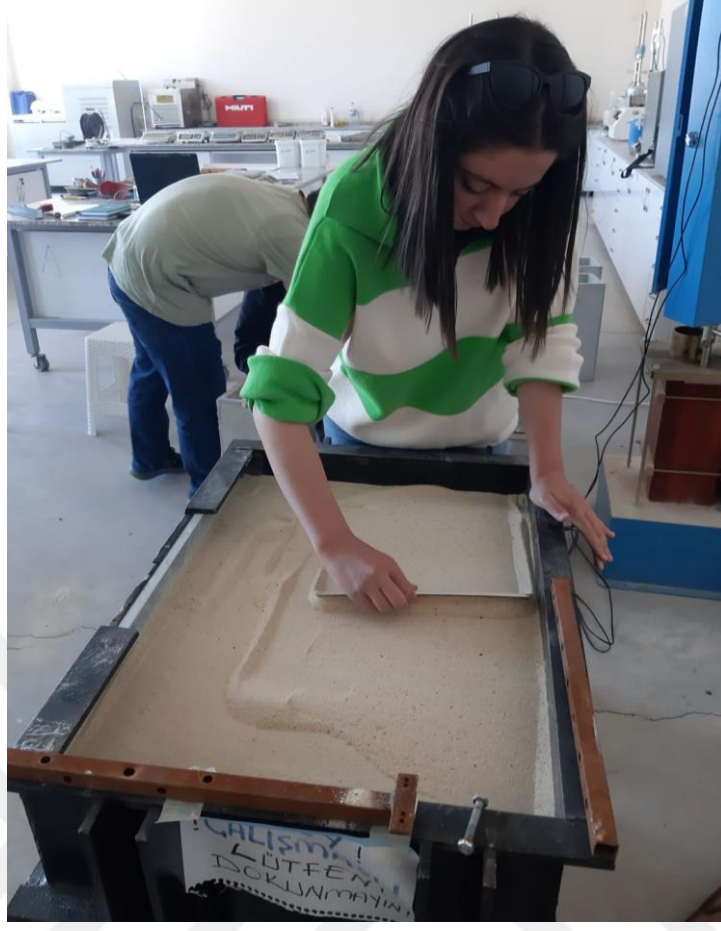
Şekil 4.28. Dolgu üst yüzeyi düzeltme işlemi.
