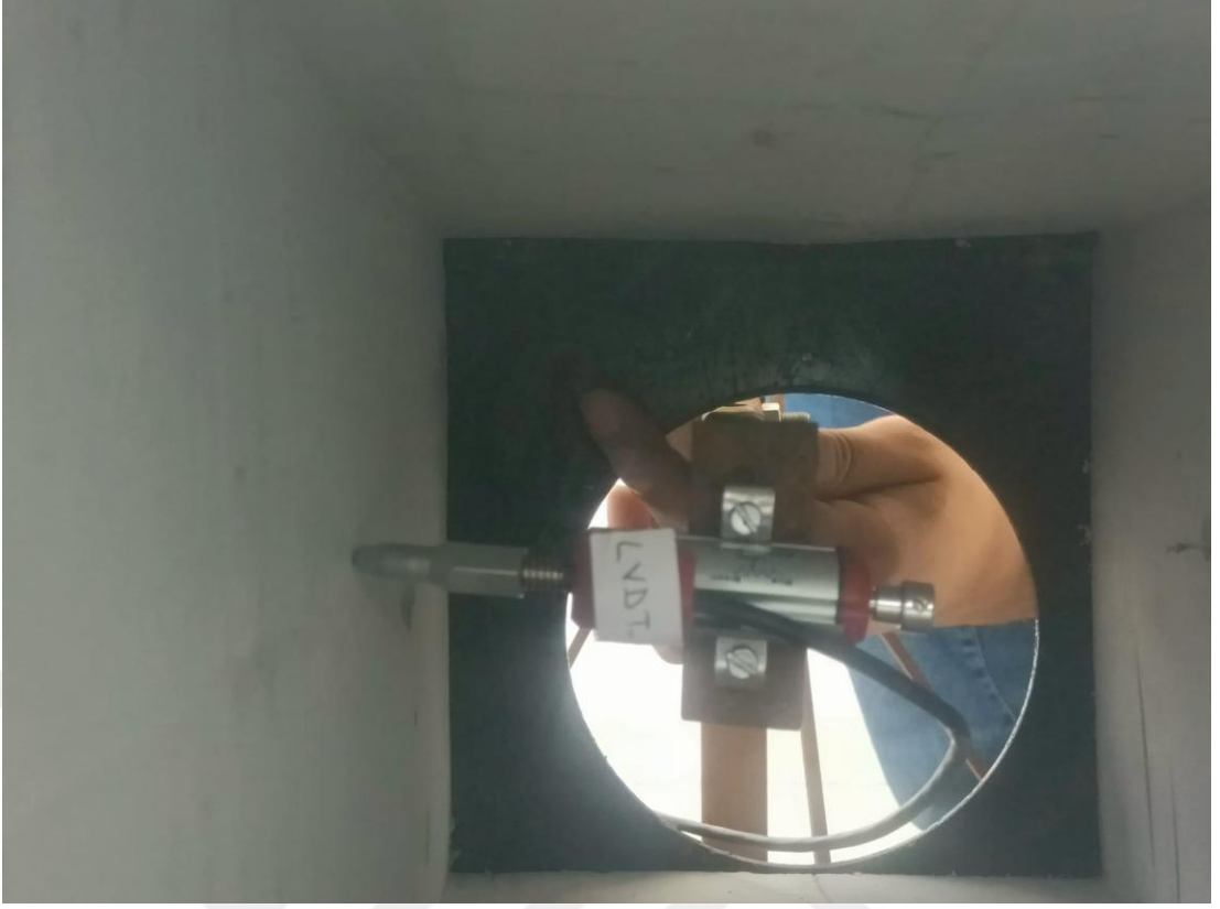
Şekil 4.26. Potansiyometrik cetvel yerleştirme işlemi.
