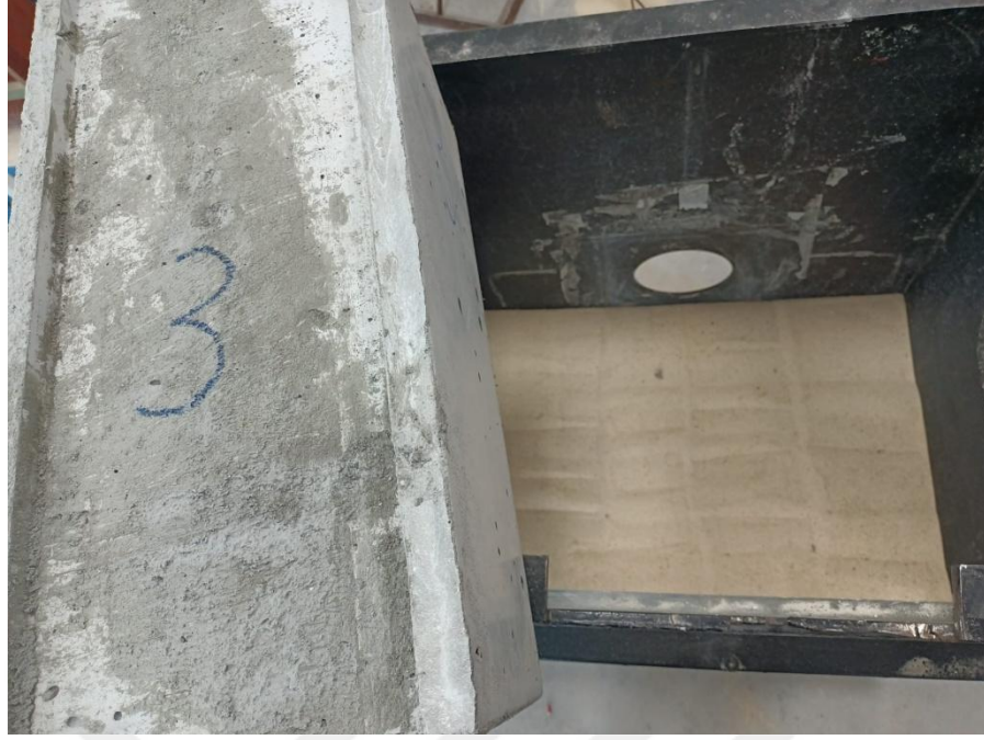
Şekil 4.49. B Tip deney numunesi ve sıkılaştırılmış zemin.
