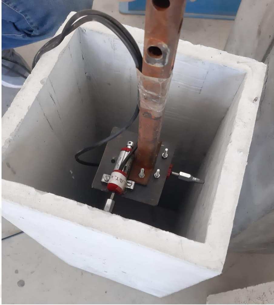
Şekil 4.16. Potansiyometrik Cetvelin Menfez Numunesi İçerisinde Yerleşim Denemesi.
