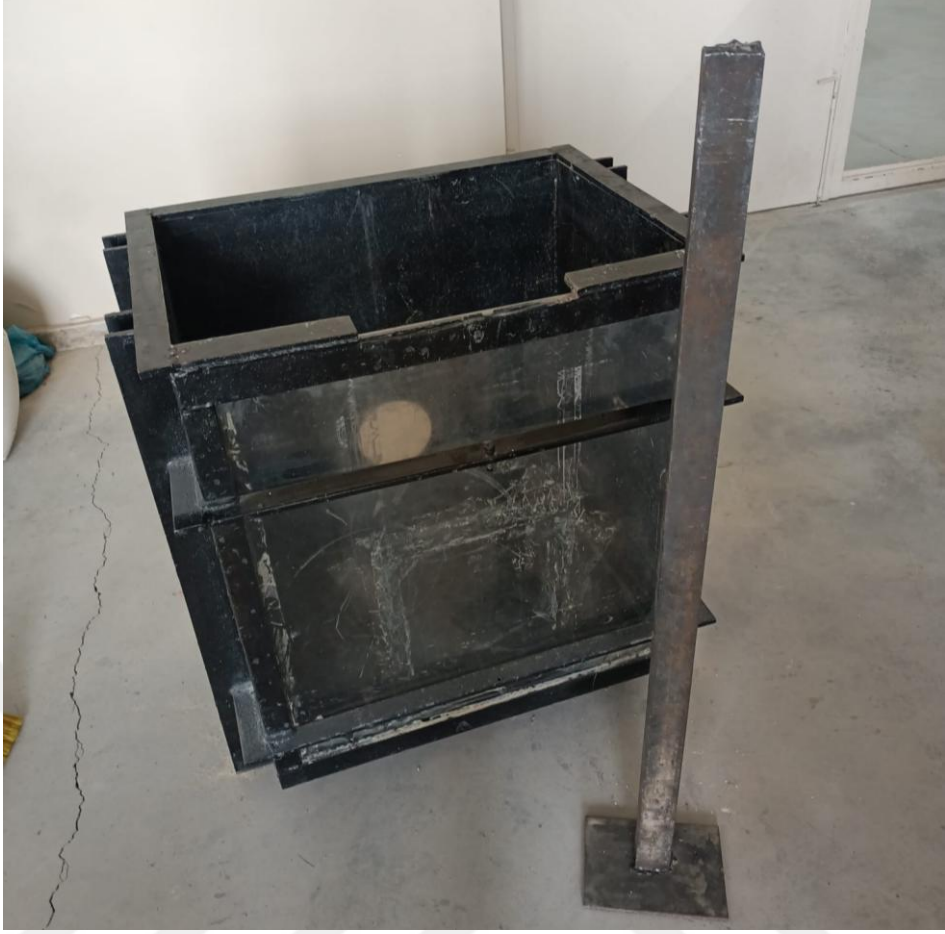
Şekil 4.11. Çelik konstrüksiyon çerçeve kutu ve sıkıştırma işleminde kullanılan alet.
