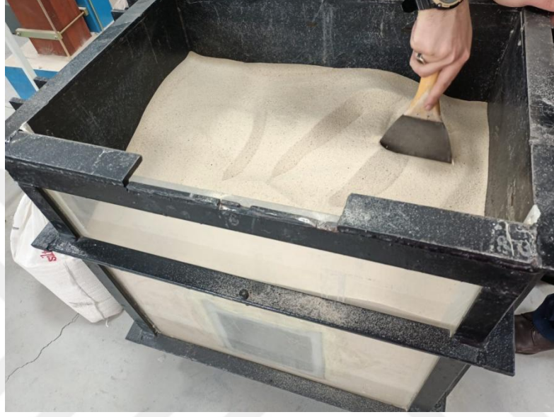
Şekil 4.45. Dolgu üst yüzeyinin düzeltilmesi.
