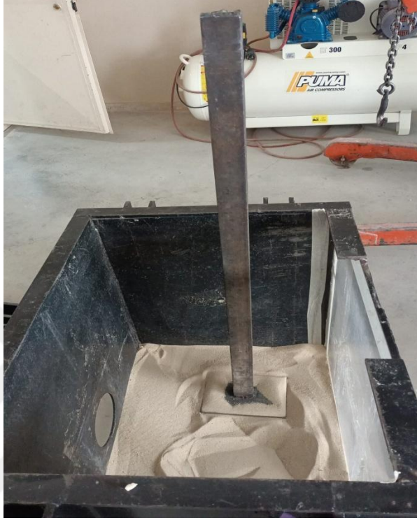
Şekil 4.32. Orta sıkı zemin sıkıştırma işlemi.
