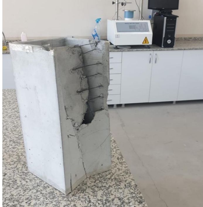
Şekil 4.29. Menfez numunesinin çatlamış hali.
