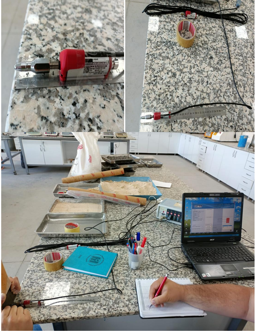
Şekil 4.13. Bilgisayar bağlantısı ile kalibrasyon.
