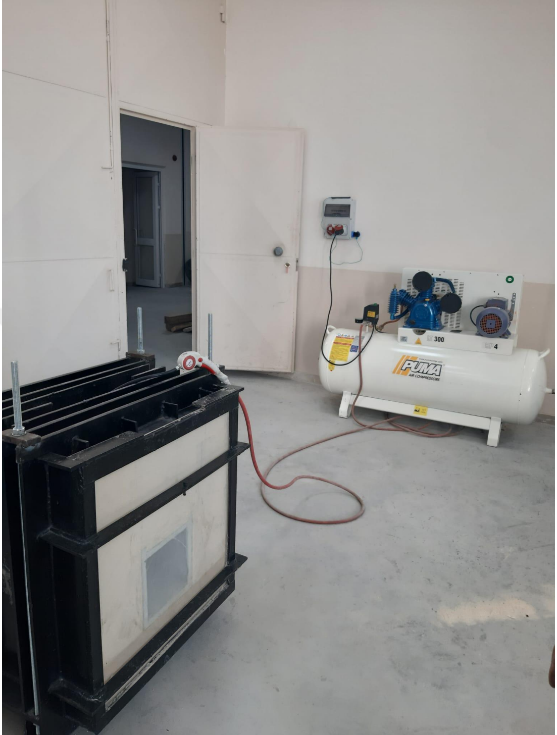
Şekil 4.9. Hava kompresörü ile sürsaj yükünün verilmesi.
