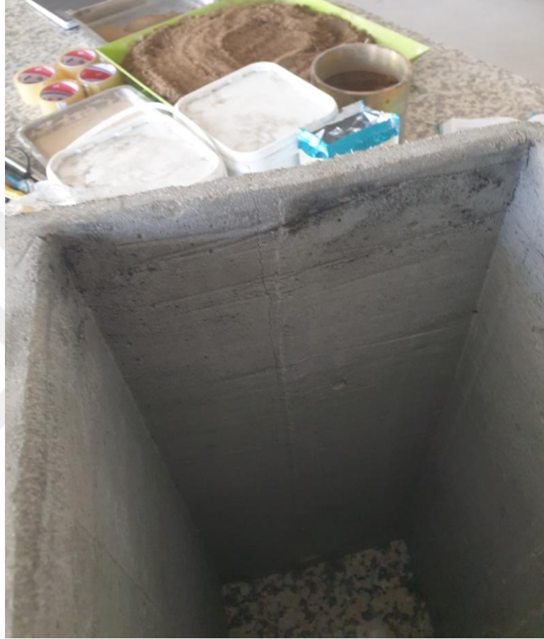
Şekil 4.34. Çatlamış menfez numunesi.
