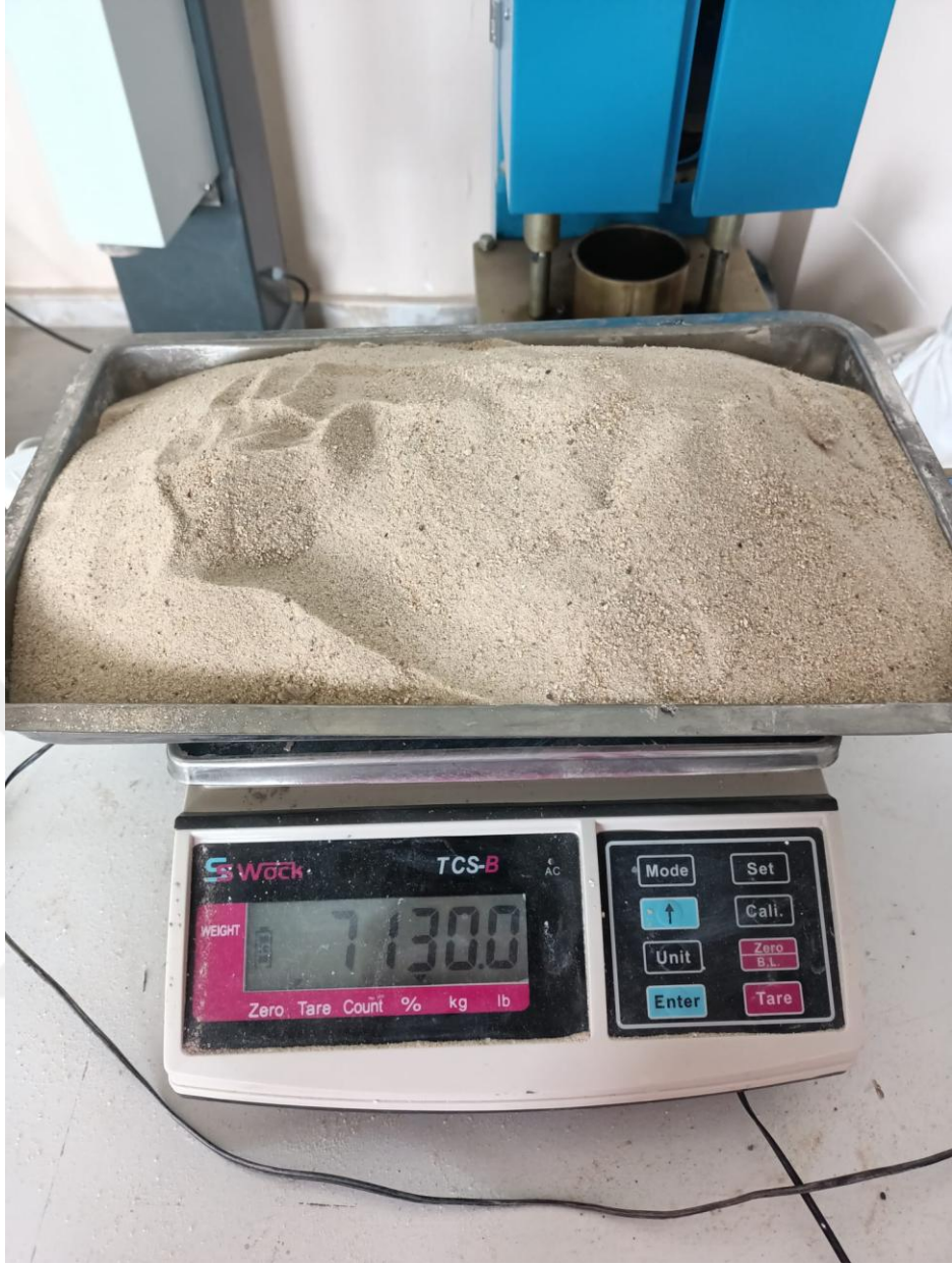
Şekil 4.7. Dolgu malzemesinin dijital tartı yardımıyla tartılması.
