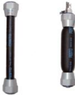
Şekil 2.1 Pnömatik Yapay Kasın Genişlemesi ve Büzülmesi (Sun, Liang, Wu, Chen, Qin and Fang 2019).
