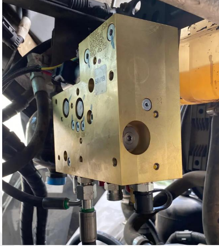
Şekil 1.7. GNSS Esaslı bir otomatik dümenleme sistemine ait elektrohidrolik yönlendirici valf (Anonim, 2023c)
