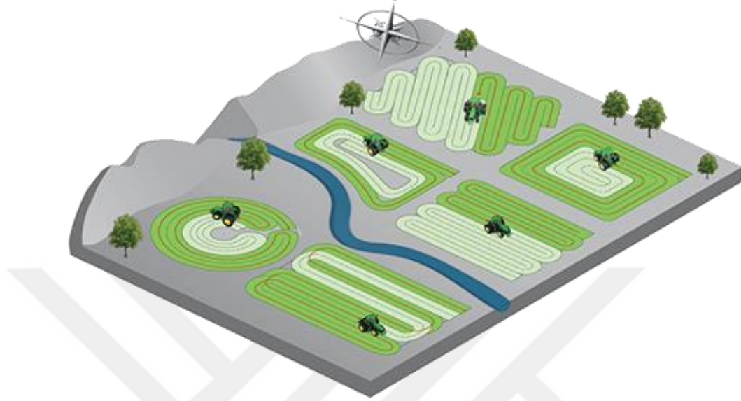
Şekil 1.5. Traktör otomatik dümenleme sistemleri ile oluşturulabilecek çalışma desenleri (Anonim, 2023a)
