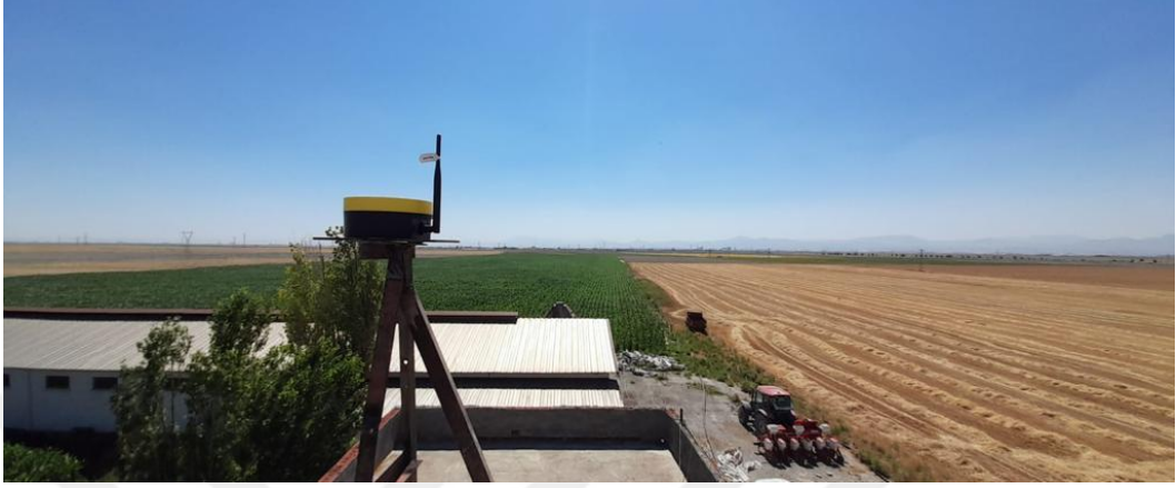
Şekil 3.7. Çalışmada kullanılan RTK baz istasyonu
