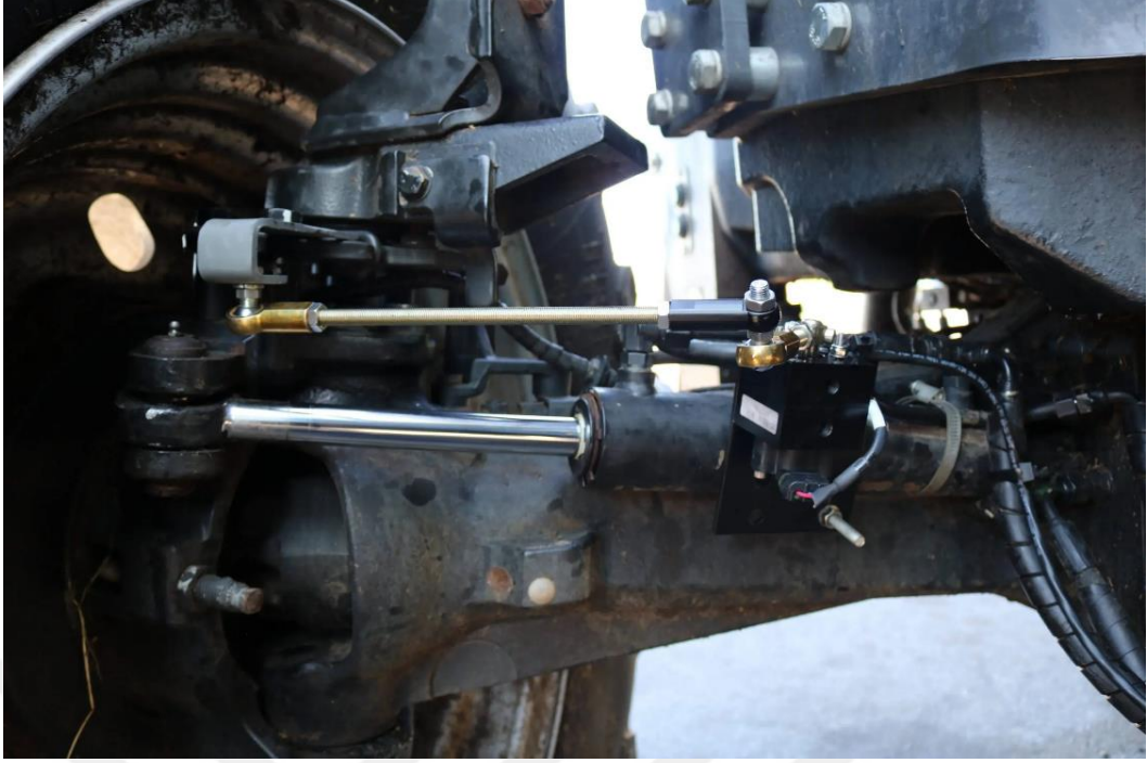
Şekil 1.8. GNSS esaslı bir otomatik dümenleme sistemine ait tekerlek açısı sensörü (Anonim, 2023d)
