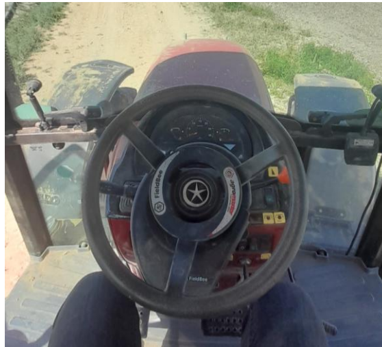
Şekil 3.12. Çalışmada kullanılan traktöre bağlanmış elektromekanik yönlendirici
