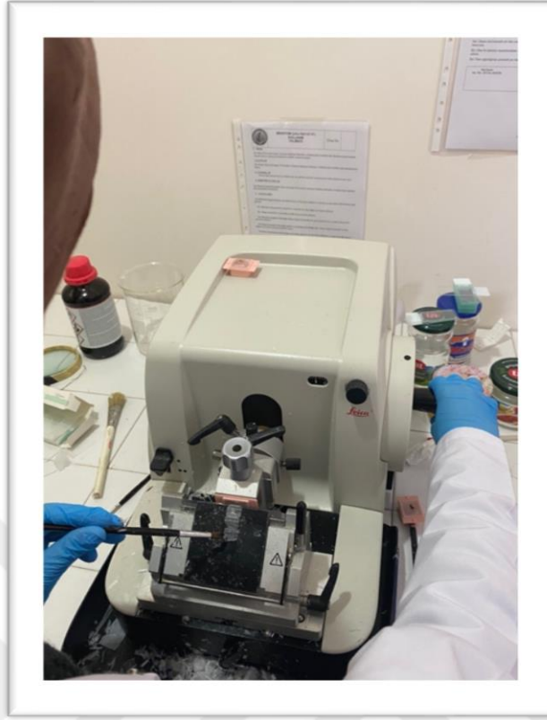
Şekil 3.10: Hazırlanan parafin bloklardan mikrotom ile kesit alınması
