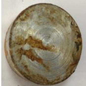
Şekil 23. Tuz Testi Sonucu Paslanan Sert Krom Kaplanmış 1.2311 Çeliği Görseli
