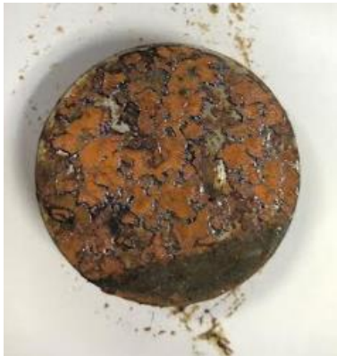
Şekil 20. Tuz Testi Sonucu Paslanan 1.2311 Çeliği Görsele
