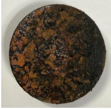
Şekil 21. Tuz Testi Sonucu Paslanan Nitrürlenmiş 1.2311 Çeliği Görseli
