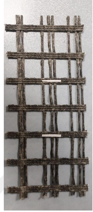
Şekil 3.28: Çekme Deneyi için Hazırlanan Geogridler Üzerindeki Referans Noktaları
