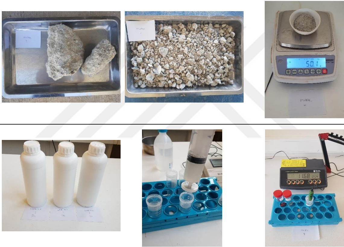
Şekil 3.10: pH Analiz Deney Aşamaları.
