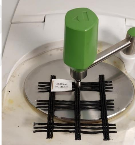
Şekil 3.32: FT-IR Analizlerinin Gerçekleştirildiği Bölge.
