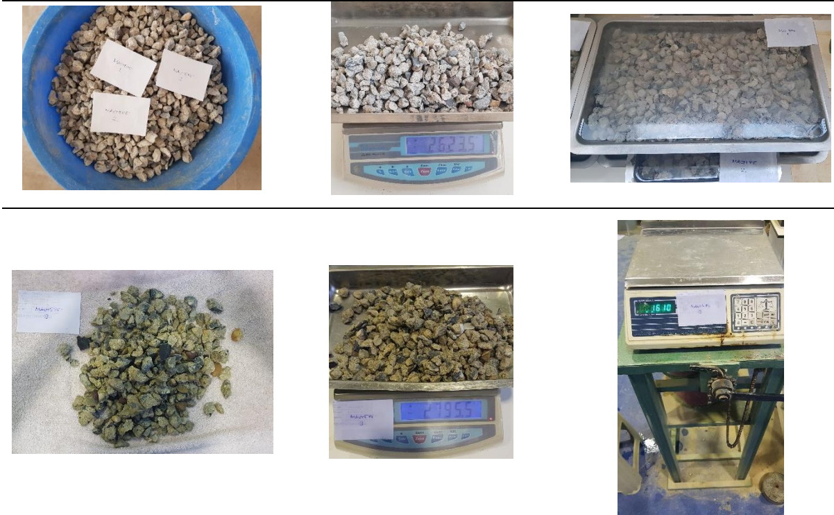
Şekil 3.6: Özgül Ağırlık ve Su Emme Deney Aşamaları.
