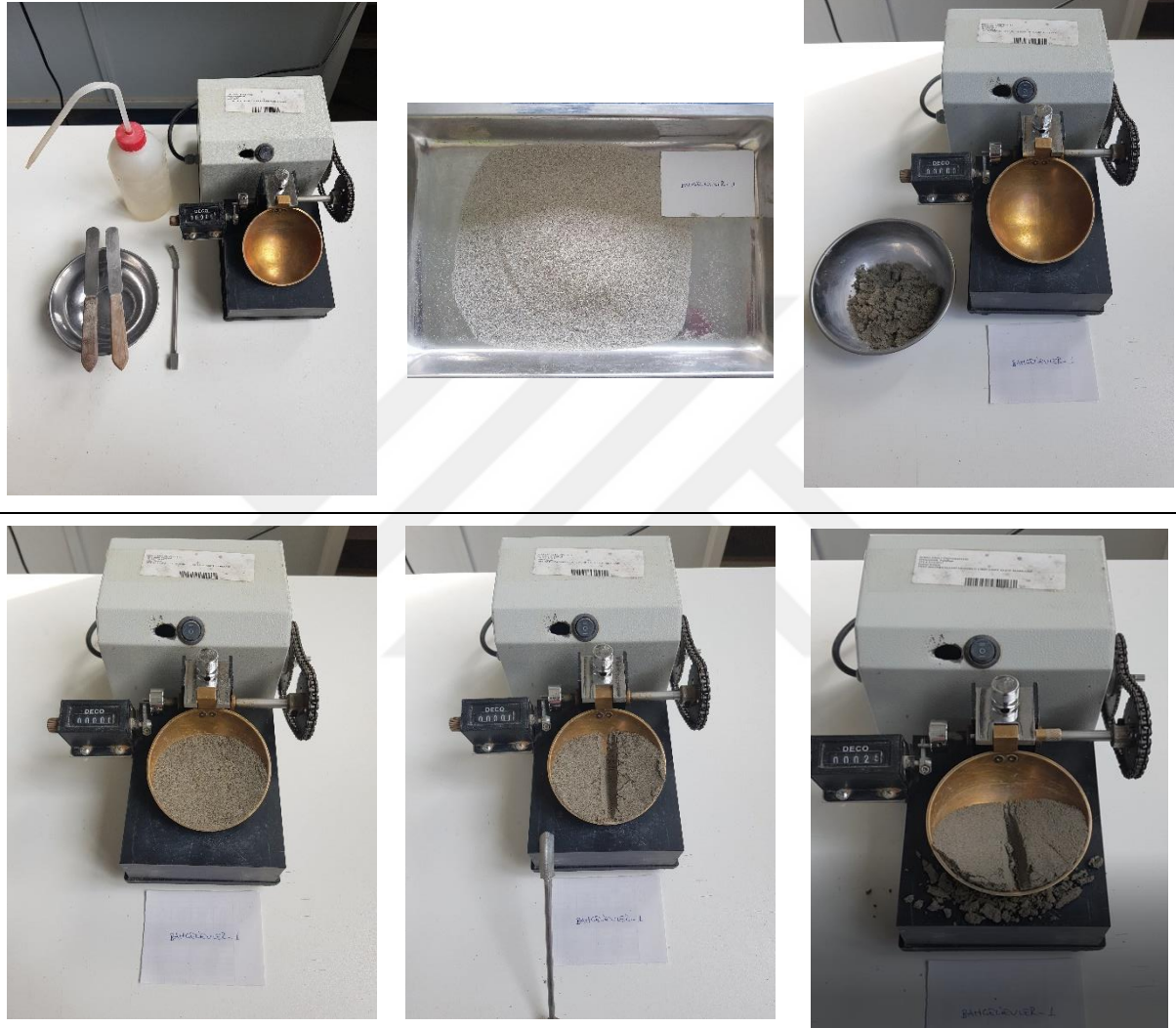
Şekil 3.8: Casagrande Cihazı ve Likit Limit Deney Aşamaları.
