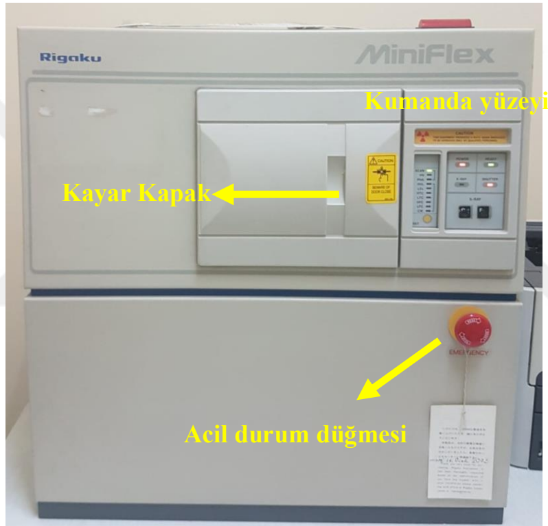
Şekil 3.9. XRD ölçümlerinin alındığı Rigaku marka Miniflex model cihaz
