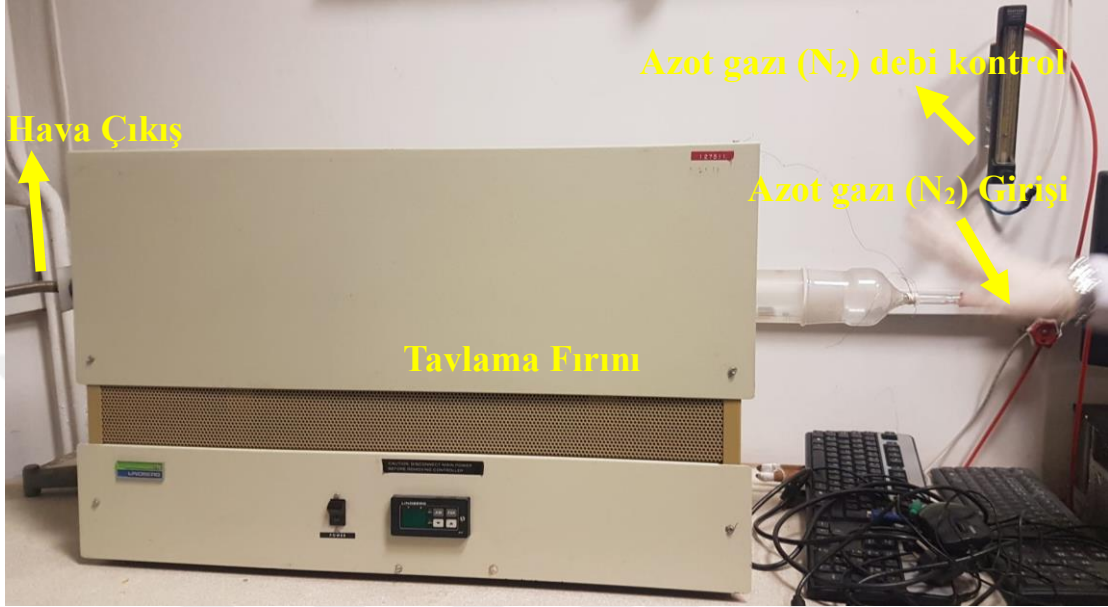
Şekil 3.7. Azot gazı debi kontrolü yapılan tavlama fırını deney düzeneği
