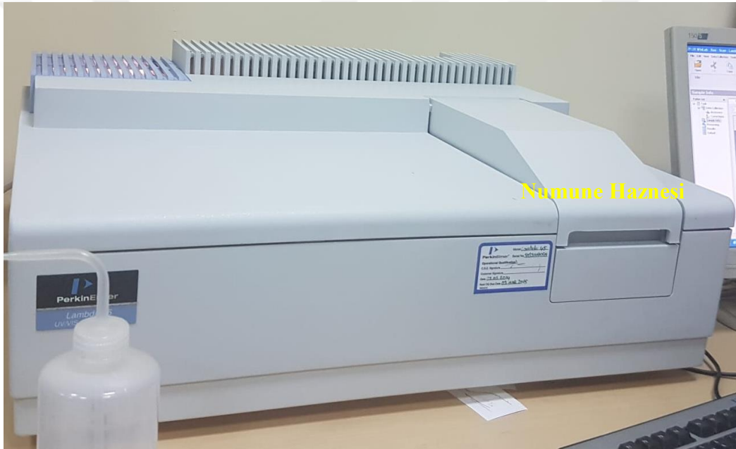
Şekil 3.15. UV-Vis ölçümlerinin alındığı Perkin Elmer Lambda 45 marka model cihaz
