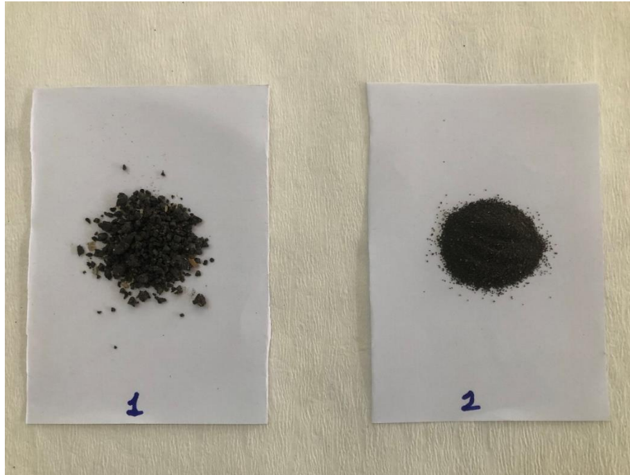
Şekil 3.4. 1) Kurutulmuş AÇEAÇ Numunesi 2) 212-300 µm gözenek çapı aralığındaki AÇEAÇ numunesi
