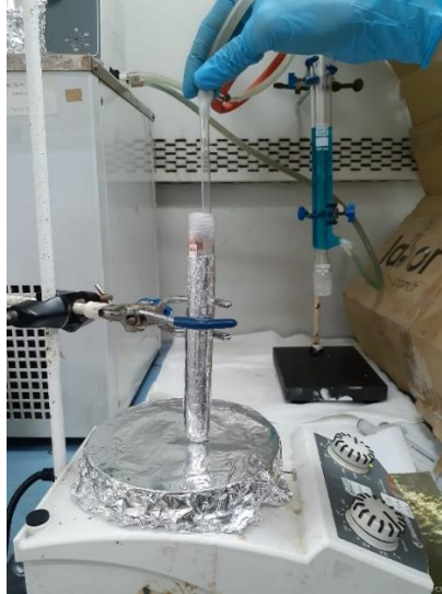
Şekil 4.9 Polimerizasyon deney düzeneği görüntüleri: A) inert gaz aşaması; B) tüp ağzının parafilmlelenmesi; C) tüpün foto-reaktöre yerleştirilmeden önceki görüntüsü
