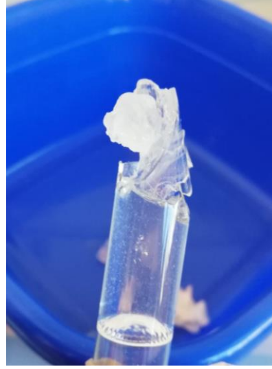
Şekil 5. 66 Yavaş karıştırma koşullarında polimerizasyon sonucu: A) polimerizasyon tüpünün görüntüsü; B) jelleşmiş polimer
