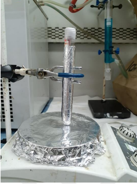
Şekil 4.9 Polimerizasyon deney düzeneği görüntüleri: Polimerizasyon deney düzeneği görüntüleri: A) inert gaz aşaması; B) tüp ağzının parafilmelenmesi; C) tüpün foto-reaktöre yerleştirilmeden önceki görüntüsü (devamı)
