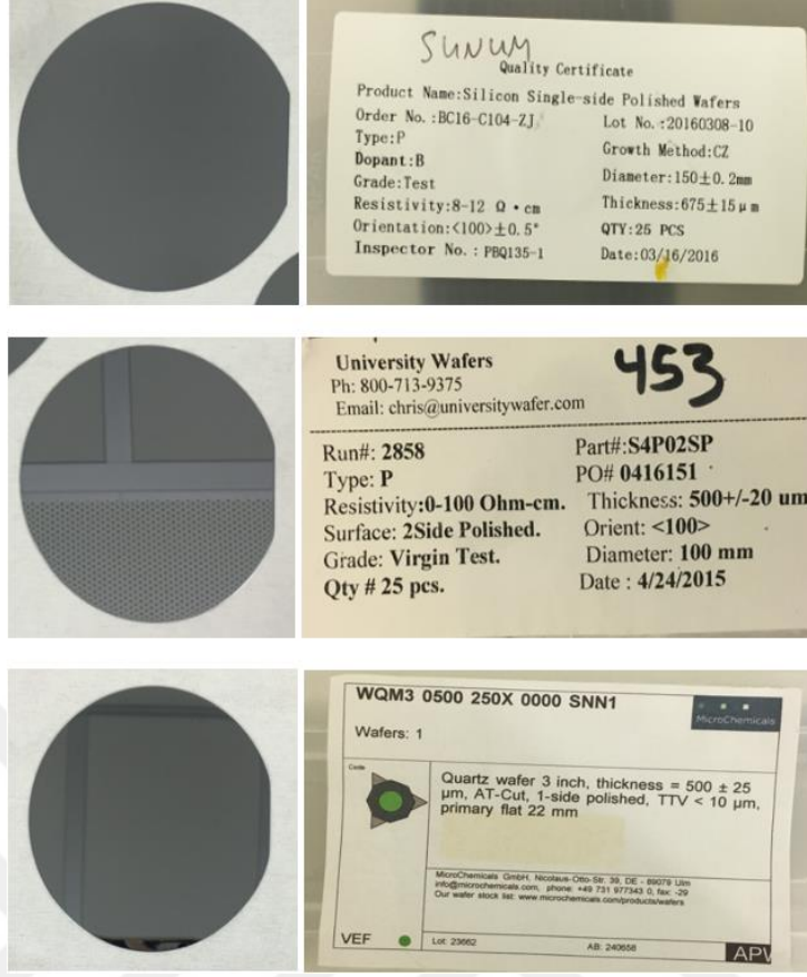
Şekil 2.9 : Çeşitli çap ve kalınlıkta bulunan her iki yüzeyi de parlatılmış silikon plaka görüntüsü.
