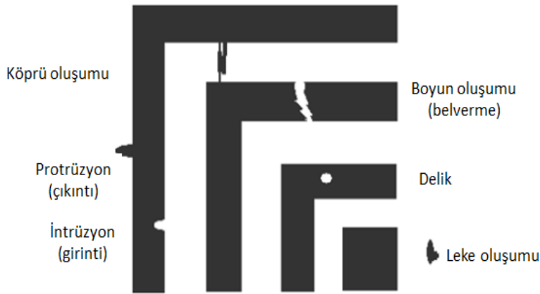
Őekil 2.10 : Maske kusurları: özellik boyutundan daha küçük kusurlar nihai boyutları ve dolayısıyla akım yoğunluęunu, elektrik alanını ve dięer cihaz parametrelerini etkiler [78].
