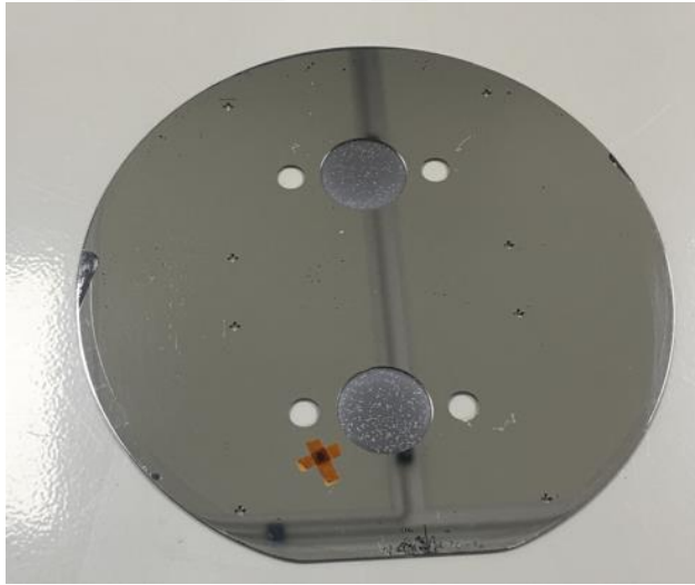
Şekil 2.34 : Kuru aşındırma yöntemi (DRIE) ile 340 µm aşınan giriş/çıkış kanalları ve PZT tetikleyici.
