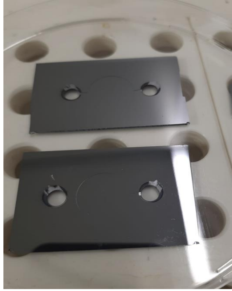
Şekil 2.36 : Fotorezisti temizlenmiş ve tasarım ebatlarına getirilmiş silikon plakanın alt yüzey görüntüsü.
