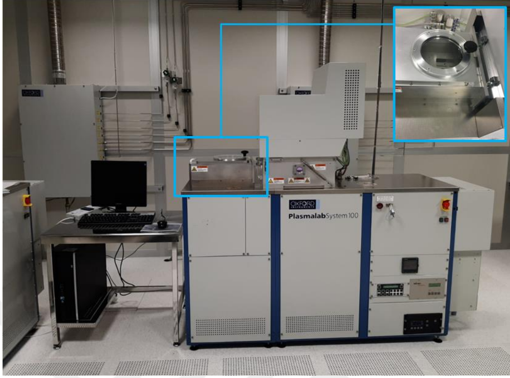
Şekil 2.31 : Kuru aşındırma yönteminin (DRIE) gerçekleştirildiği cihaz görüntüsü.
