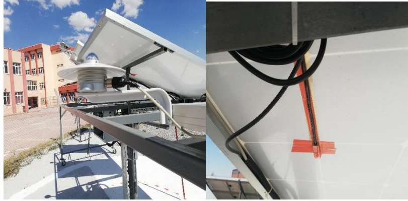
Şekil 3.32. Modül üzerindeki ışınım piranometrelerinin yerleşimi
