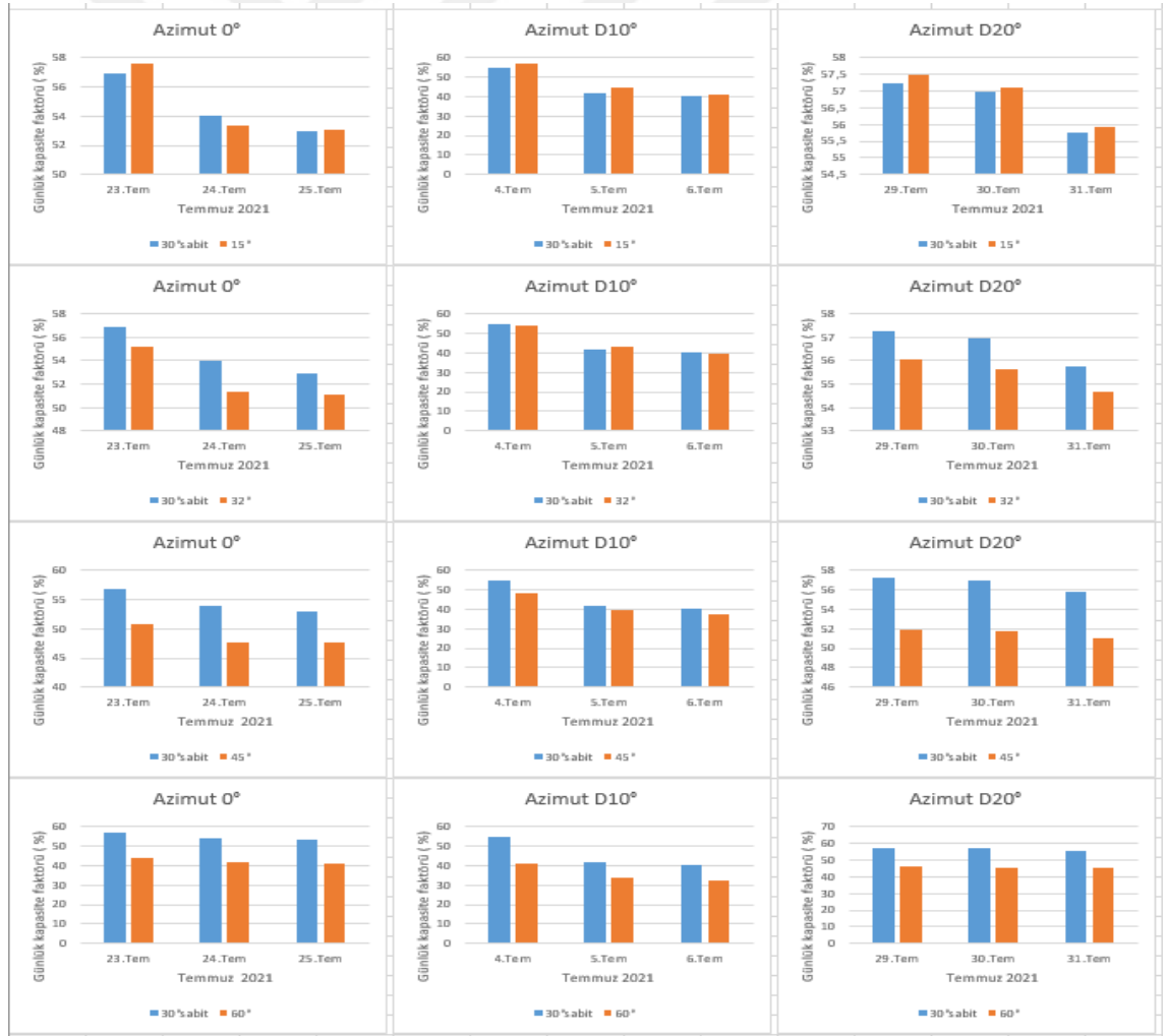
Şekil 7.25. PV panellerin Günlük dolgu faktörü Azimut 0°, D10° ve D20°
