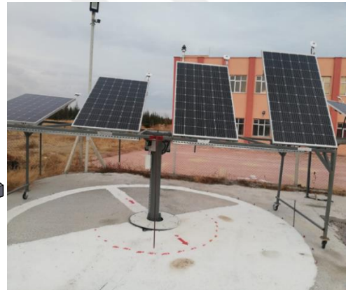
Şekil 3.31. Azimut açısı ayarlanabilen PV panel sistemi
