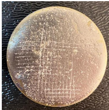
Şekil 5.19. Epoksi kaplamalı numune için yapışkan bant uygulama öncesi.
