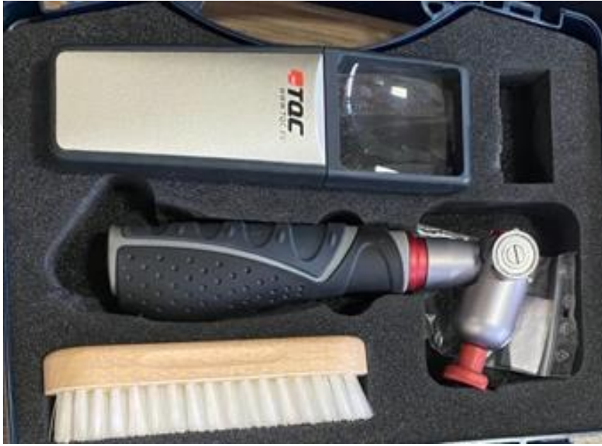
Şekil 4.9. Cross-cut yapışma test kiti.
