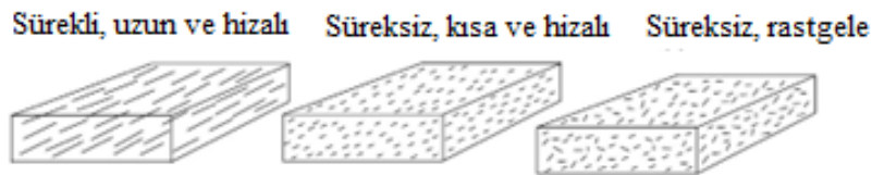
Şekil 2.8. Fiber partikül takviyeli kompozit şeması [23].
