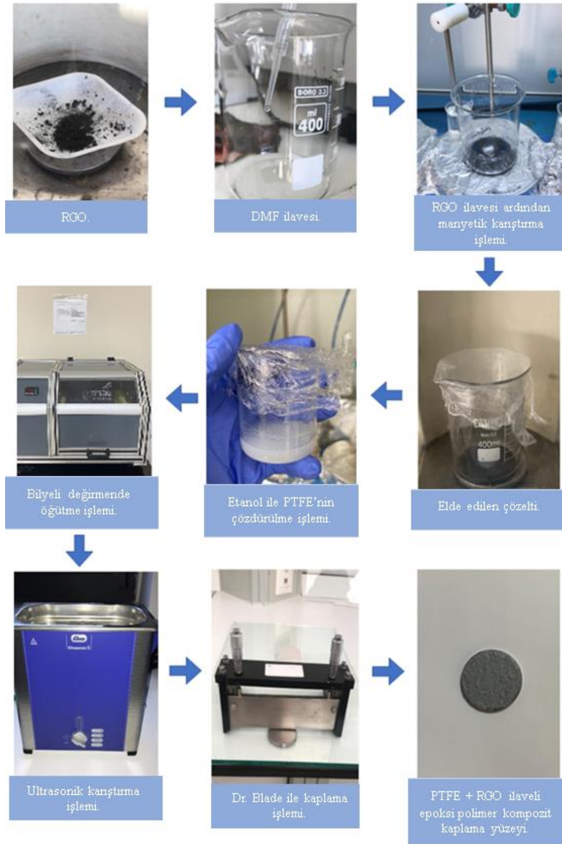
Şekil 4.4. RGO+PTFE katkılı epoksi kaplama işlem aşamaları.
