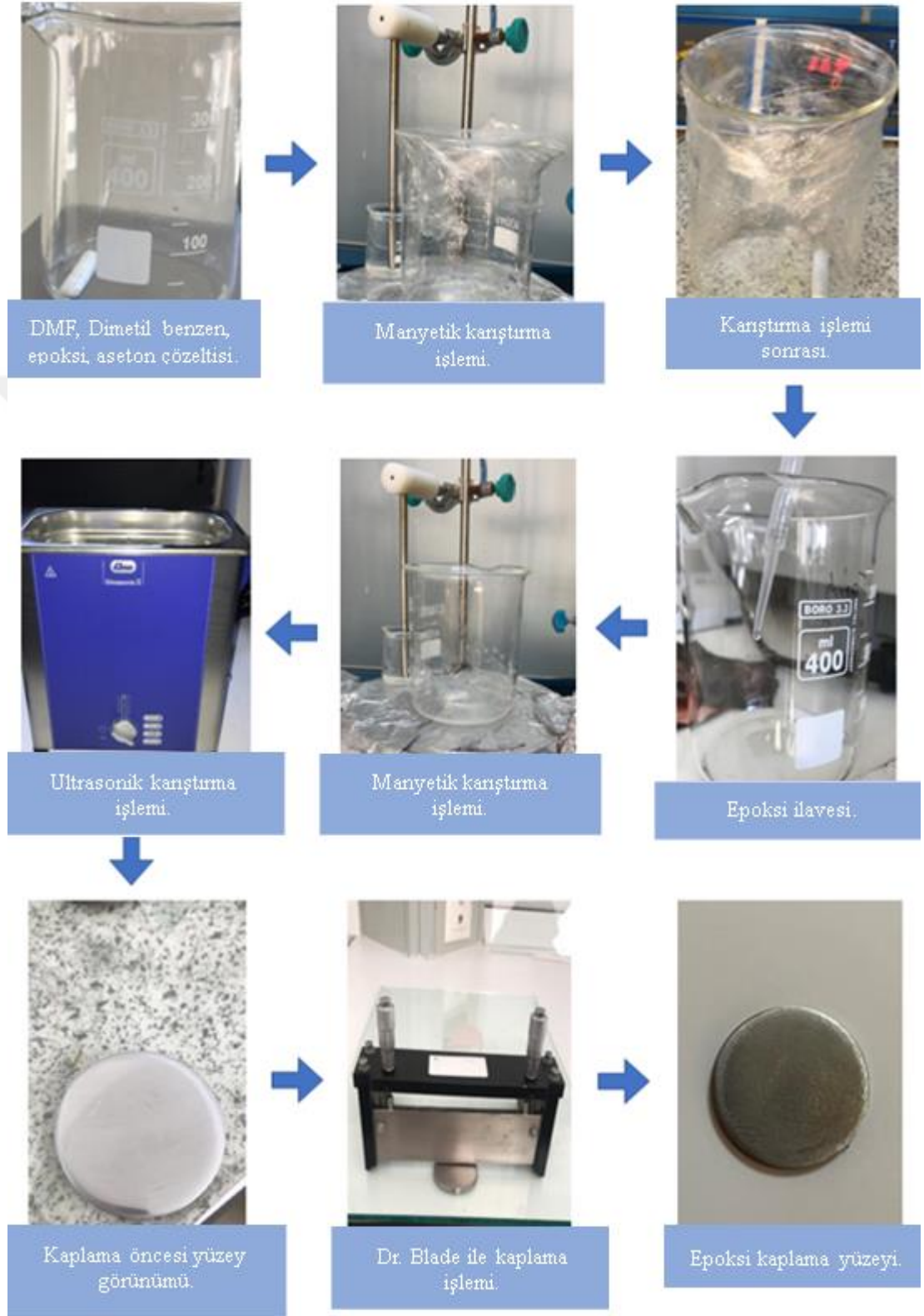
Şekil 4.2. Epoksi kaplama işlem aşamaları.
