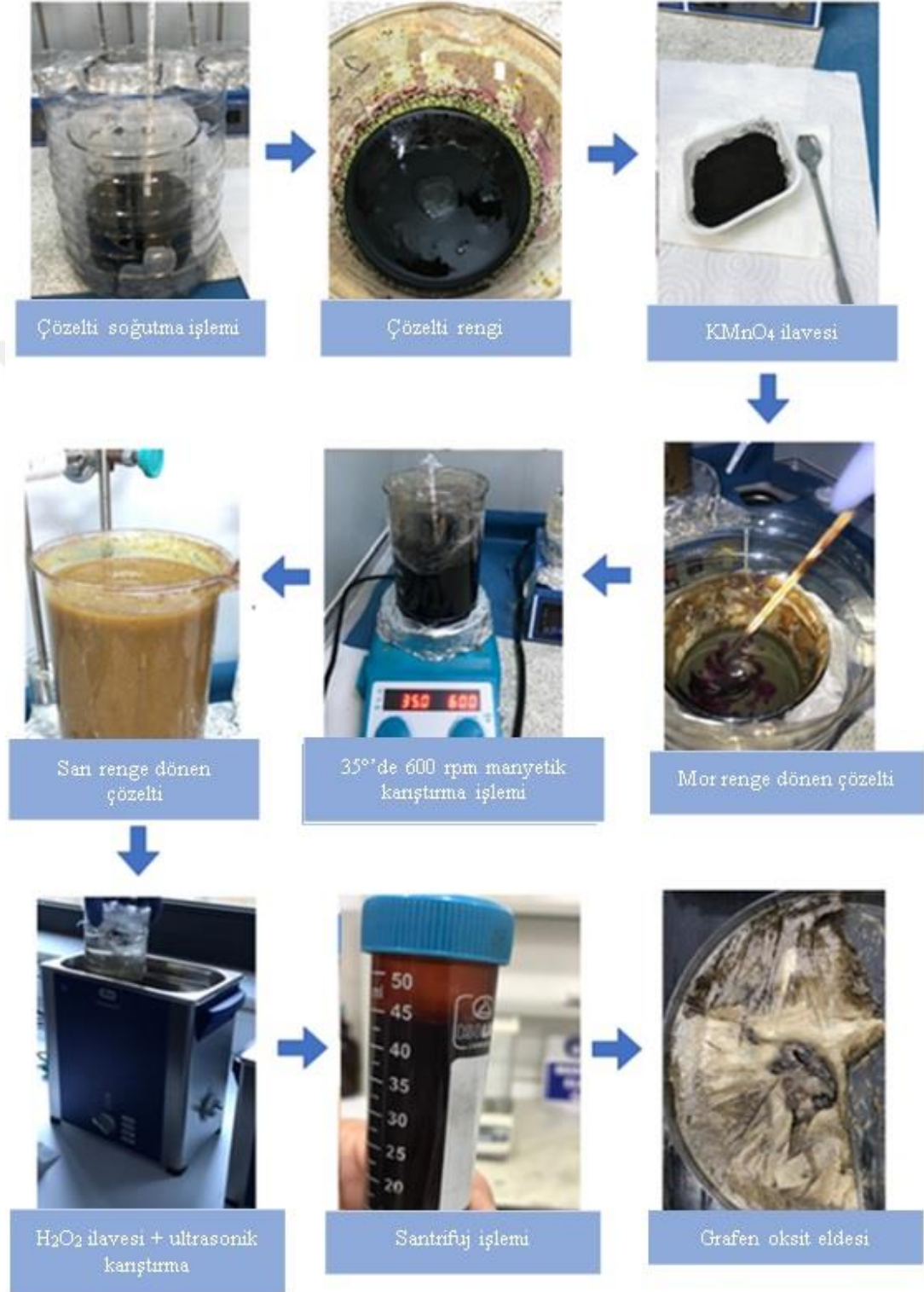
Şekil 4.1. Pulcuklu grafitten grafen oksit üretim aşamaları.
