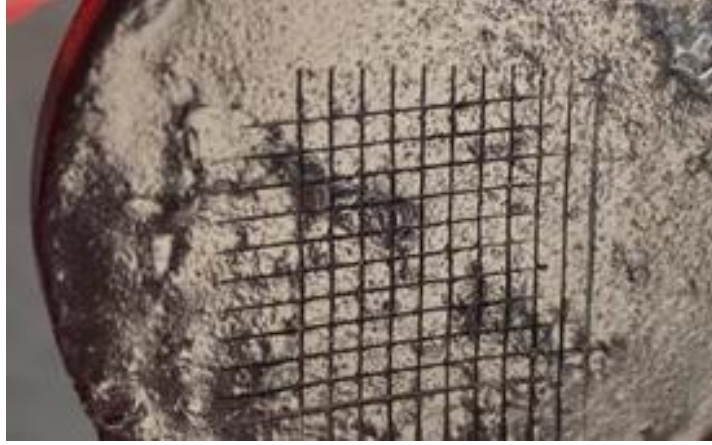
Şekil 5.24. RGO+PTFE ilaveli yüzeye yapışkan bant uygulama öncesi.
