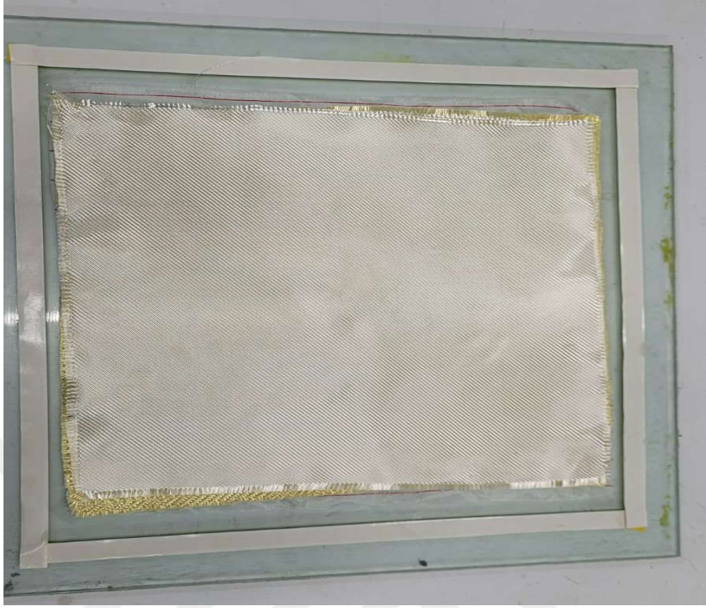
Şekil 5.7: Elyaf kumaşların cam plaka üzerine serilmesi.
