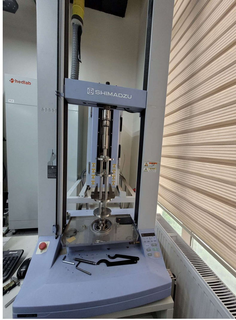
Şekil 5.18: Çalışmada 3 nokta eğme deneyi uygulaması için tercih edilen Shimadzu test cihazı.
