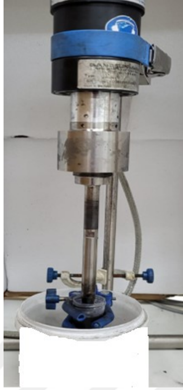
Şekil 5.12: Ultra sonik karıştırma cihazında grafen-epoksi karıştırılması.
