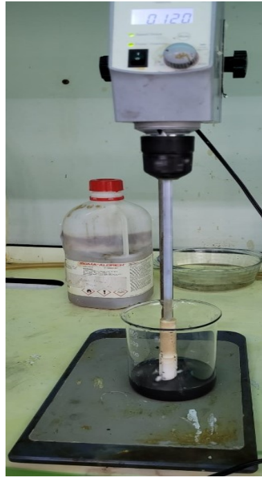
Şekil 5.13: Mekanik karıştırıcıda grafen-epoksi karıştırılması.
