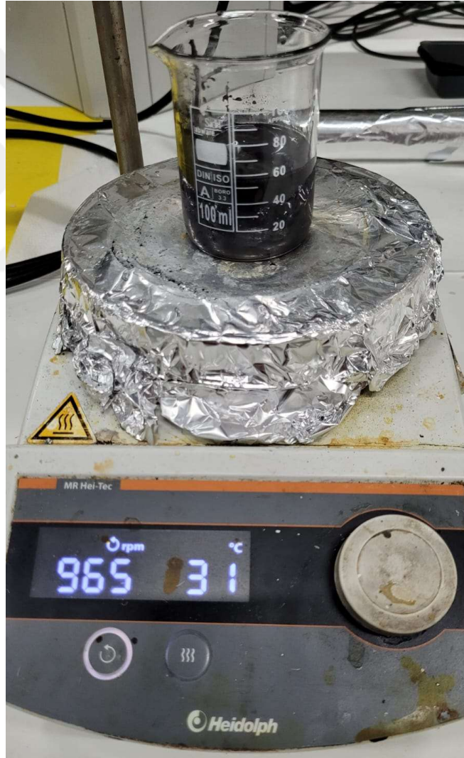
Şekil 5.11: Manyetik karıştırıcıda epoksi-grafen karışımı.
