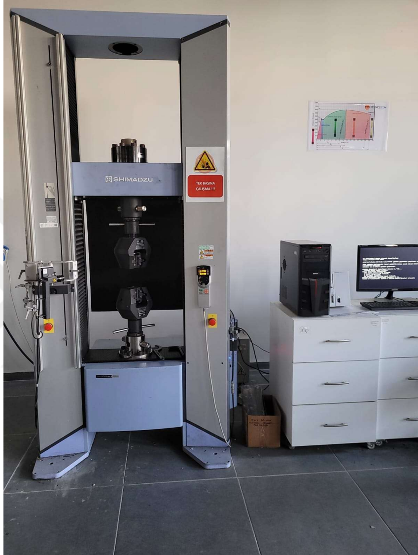
Şekil 5.16: Çalışmada çekme deneyi uygulaması için tercih edilen Shimadzu AG-X Plus test cihazı.
