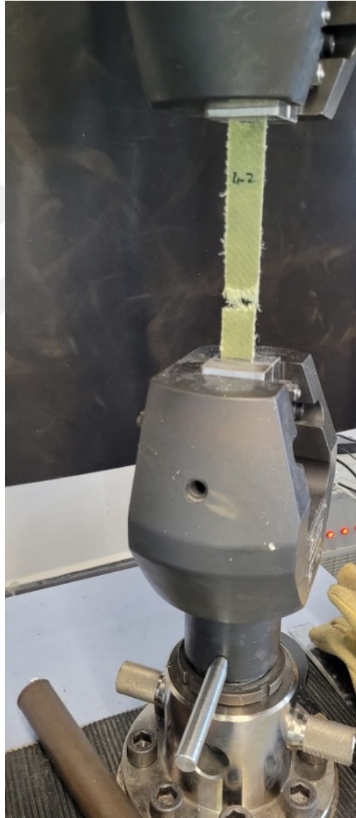
Şekil 6.1: Çalışmada çekme deneyi uygulaması için tercih edilen Shimadzu AG-X Plus test cihazında yapılan deney esnasındaki bir numune.
