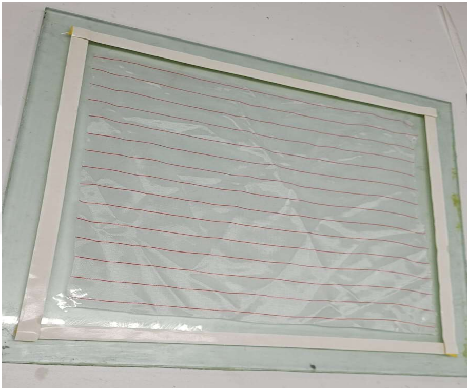
Şekil 5.6: Sızdırmaz bantların cam plaka üzerine yapıştırılması ve peel ply yerleştirilmesi.
