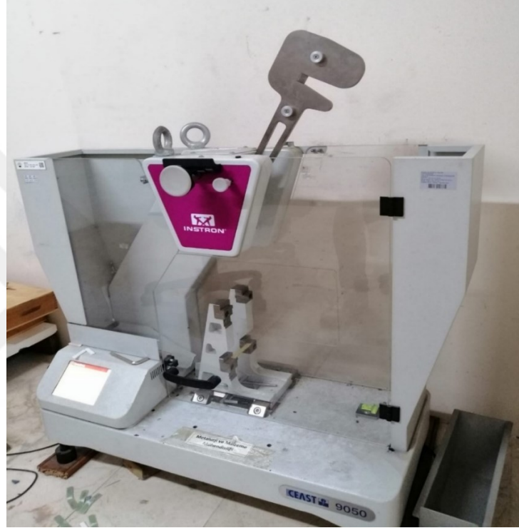
řekil 6.10: alıřmada darbe deneyi uygulaması iin tercih edilen Instron Ceast 9050 cihazında yapılan deney esnasındaki bir numune.
