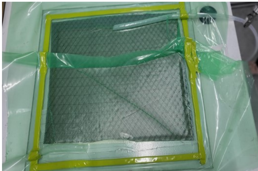
Şekil 5.10: Vakum naylonu ve hortumların yerleşimi.
