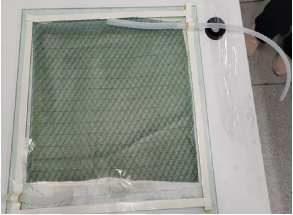
Şekil 5.8: Peel ply kumaş ve flow mesh yerleşimi.
