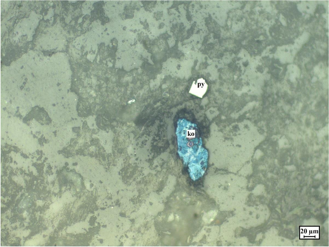
Şekil 3.7. Serbest kovellin ve pirit'lerden görünüm. (ko: kovellin, py: pirit).
