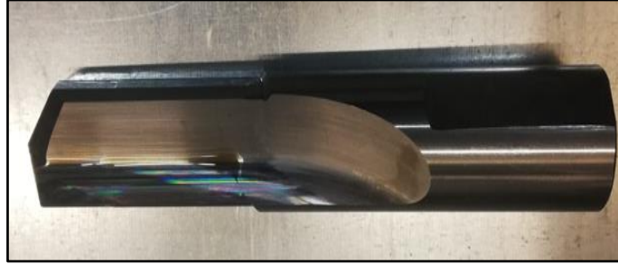
Şekil 74. Uygulama Yapılacak 90 HRC Sertliğinde Karbür Kesici Resmi
