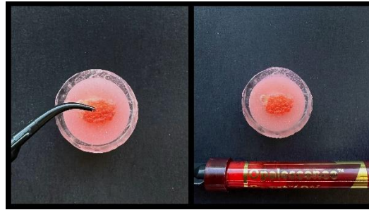
Şekil 3.10. %40 hidrojen peroksit içeren beyazlatma ajanının örnek yüzeyine uygulanması
