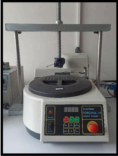
Şekil 3.5. Örneklerin parlatma işleminin yapıldığı polisaj cihazı (Forcipol IV)
