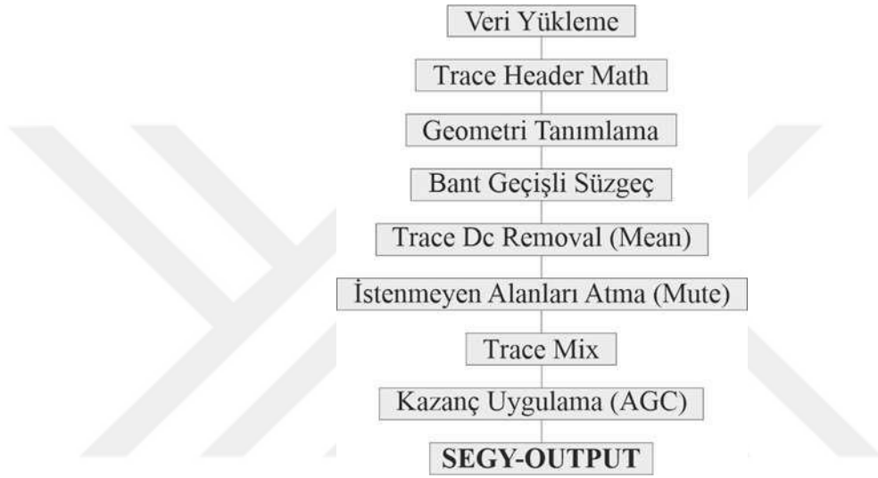
Şekil 3.10 Tek kanallı sismik verilere uygulanan veri işlem adımları.
