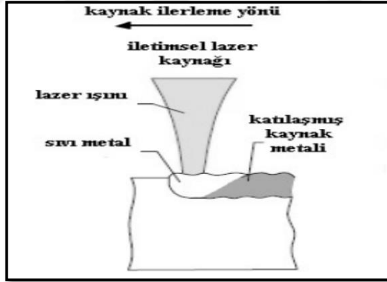
Şekil 3.4. İletimsel lazer kaynağının şematik gösterimi [52].
