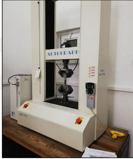
Şekil 5.7. Çekme testinin yapıldığı cihaz.
