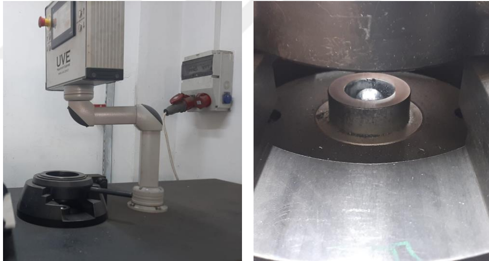
Şekil 5.8. Erichsen çökertme testinin yapıldığı cihaz ve kalıbı.
