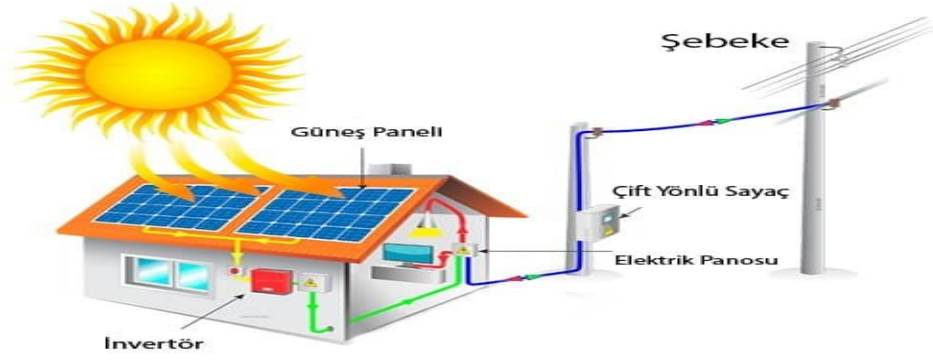
Şekil 4.13. Şebekeye bağlı fotovoltaik sistem (URL-14)
