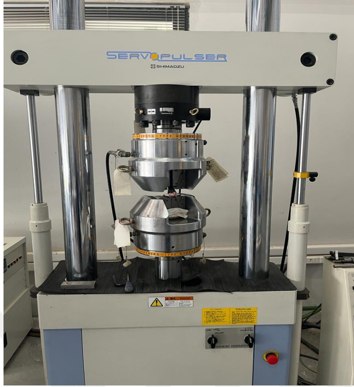
Şekil 26. Çekme testi (Shimadzu EHFEV200k2 marka/model cihaz kullanıldı)
