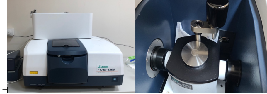
Şekil 3.3. Jasco FT/IR-6800 Spektrometresi ve ATR birimi
