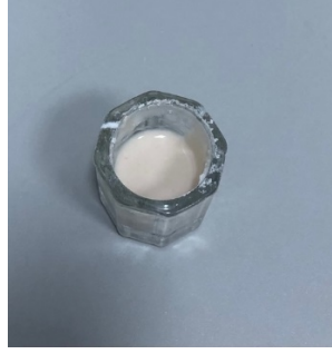
Şekil 3.5. Spektrum alınmadan hemen önce uygun toz-likit oranında karıştırılan PMMA
