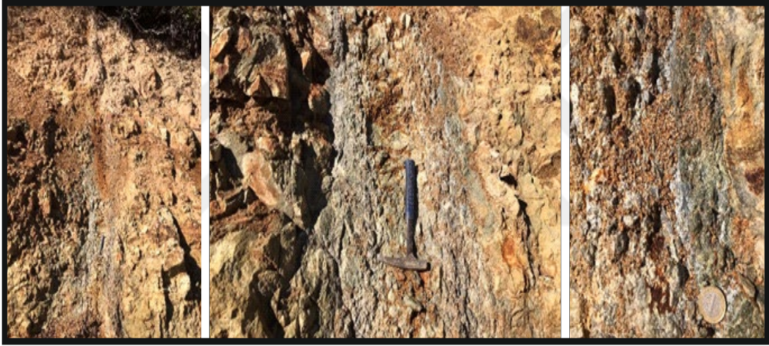
Şekil 16. Çıra tepenin güneyindeki volkanik birimler içinde sülfid damarları.
