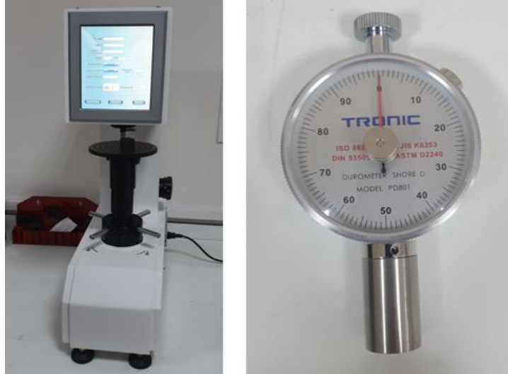
Şekil 3.8. Deneylerde kullanılan makro sertlik test cihazı ve Shore D test aleti
