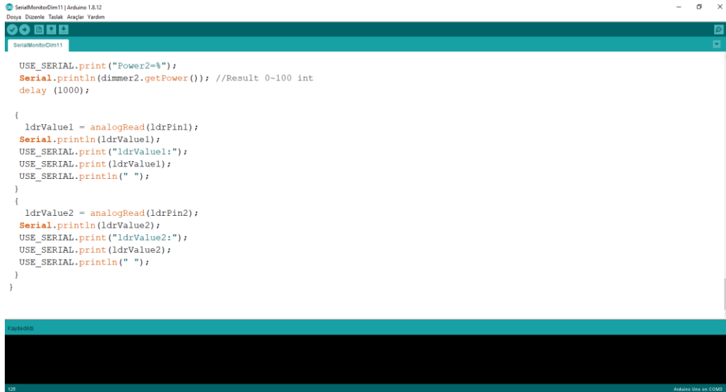
Şekil 4. 23. Ldr ve lamba güç değerlerinin Arduino üzerinden gösterim kodları
