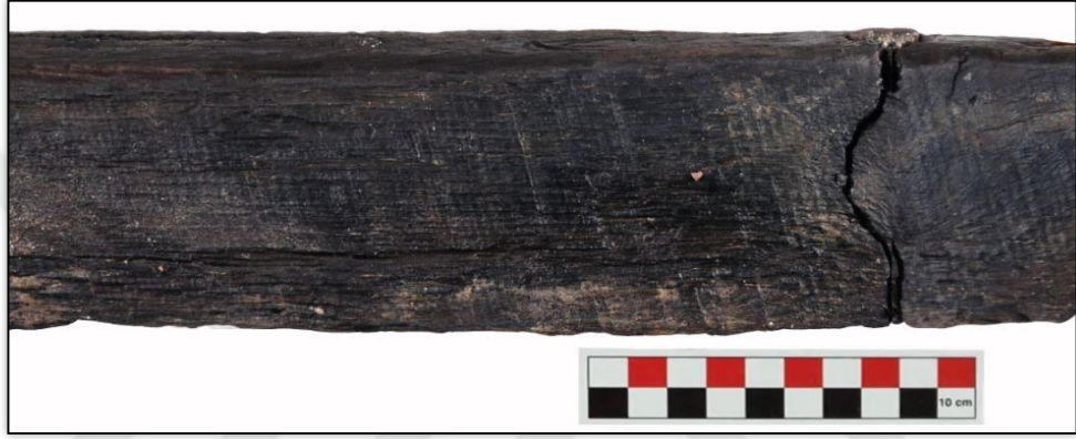
Şekil 31: E6 numaralı eğrinin kış yönden testere izi detayı
