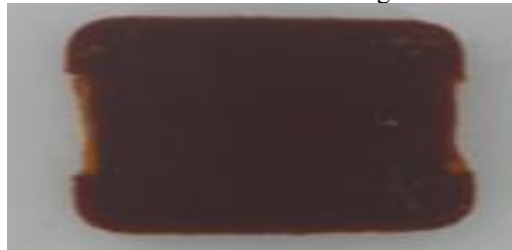
e. 60°C sıcaklıkta 120 gün yaşlandırılmış numune görüntüsü
