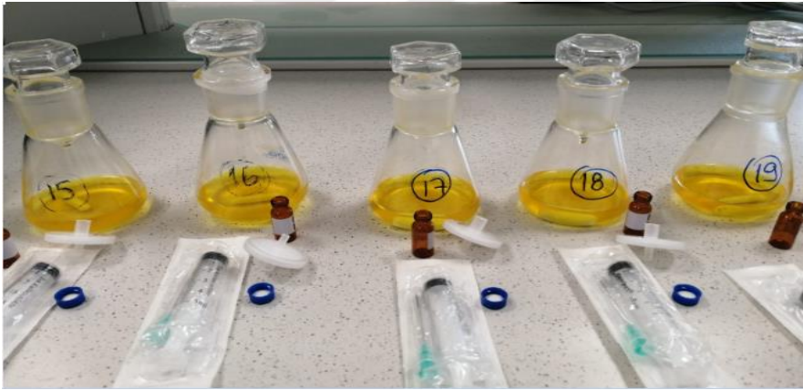
Şekil 2.3. Stabilizör miktarı tayini için numune hazırlama
