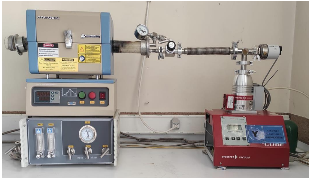
Şekil 1.1. Katı hal sentezlerin yapıldığı atmosfer kontrollü tüp-fırın.
