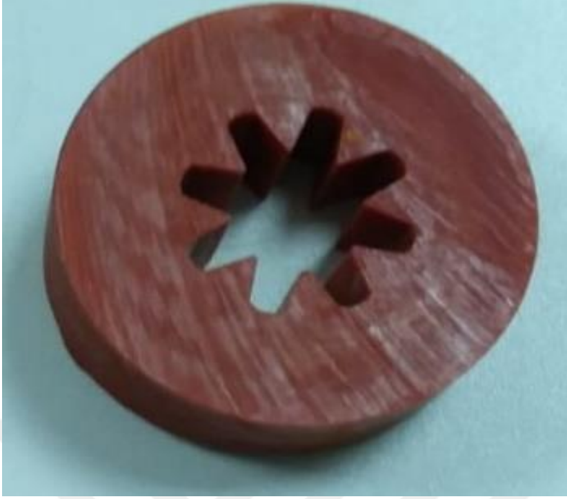
Şekil 2.3. Çift Esaslı (DB) katı roket yakıtı kesit görünüşü.
