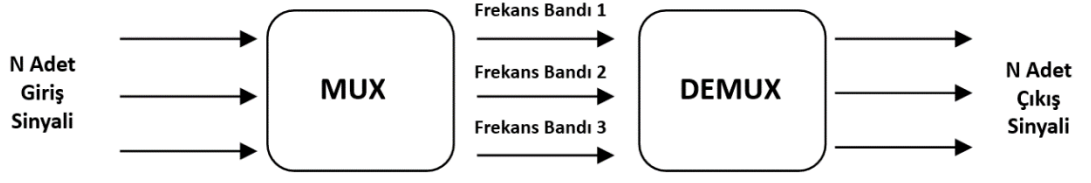
Şekil 2.6 Frekans bölmeli çoğullama iletim hattı şeması
