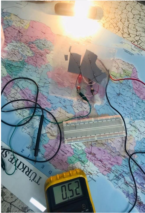
Şekil 3.2. FV hücrenin akım-gerilim-güç hesaplama deneyi gösterimi.
