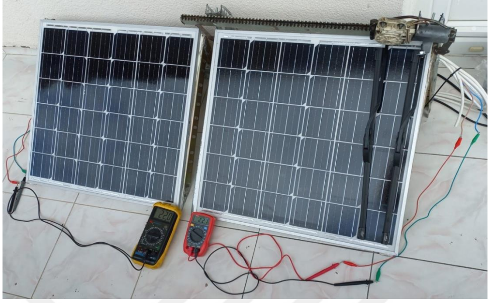
Şekil 3.15. Deney yapılan güneş panelleri. Temizleme mekanizmalı panel sağda yer almaktadır.
