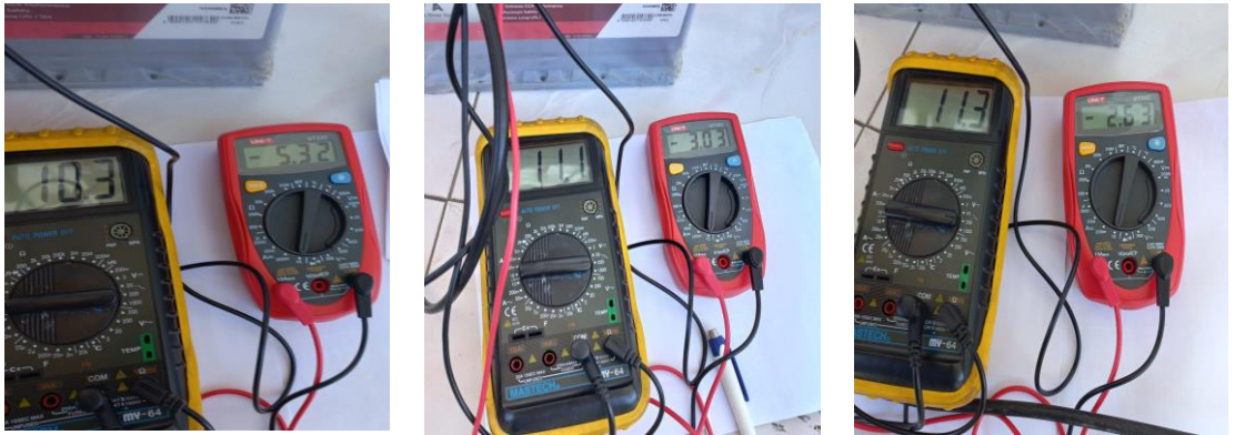
Şekil 3.19. Akü çıkışından elde edilen gerilim ve akım değerlerinin okunması.
