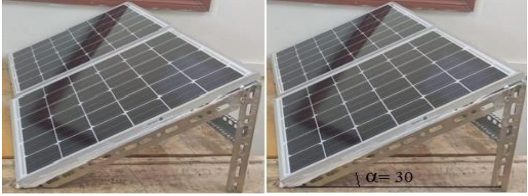
Şekil 3.7. Güneş panelinin zemine 30 0 derecelik açıyla yerleştirilmesi.
