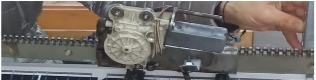
Şekil 3.9. 12V DC motorun kremayer dişli üzerine yerleştirilmesi.
