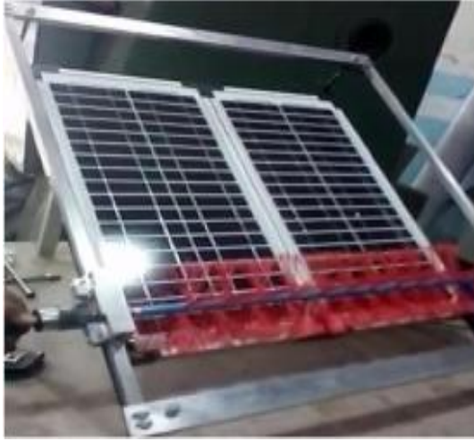
(a) Fırça Temizleme Sistemi (BCS) (Kawamoto ve Shibata, 2015).
