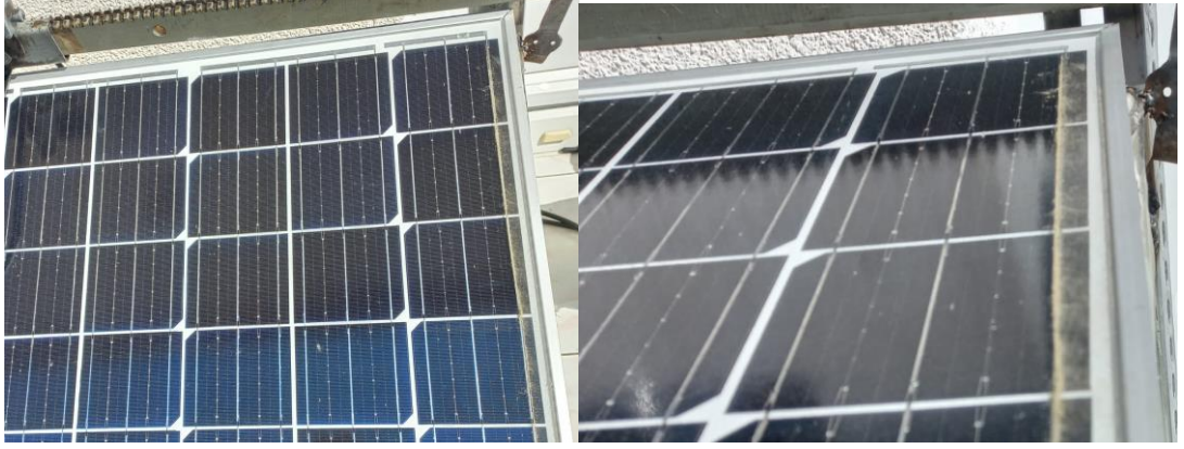
Şekil 3.21. Kuru temizlenen panel kenarında toz birikmesi.
