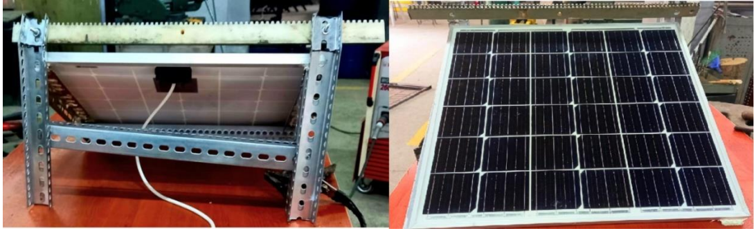
Şekil 3.8. Kremayer dişlisinin panel üzerine yerleştirilmesi.
