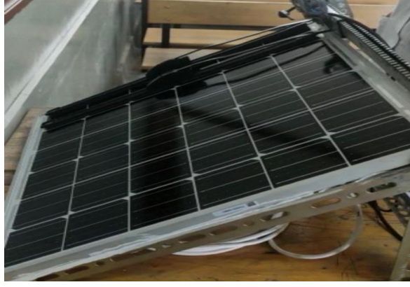
Şekil 3.13. Mekanizmanın panel üzerine monte edilmesi.
