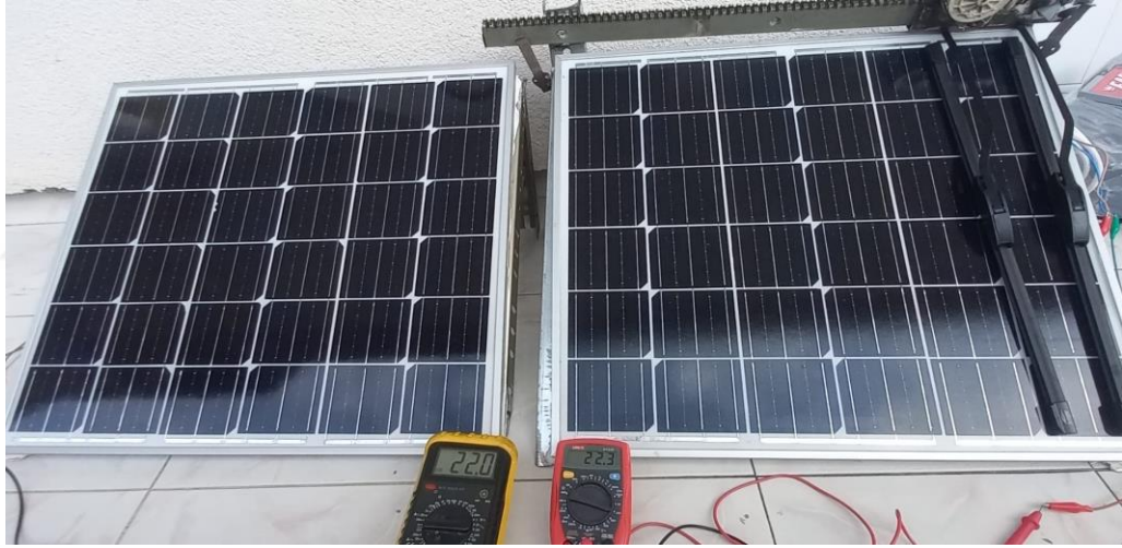
Şekil 3.24. Tozlu ve temiz panel çıkış gerilimleri ölçümü.
