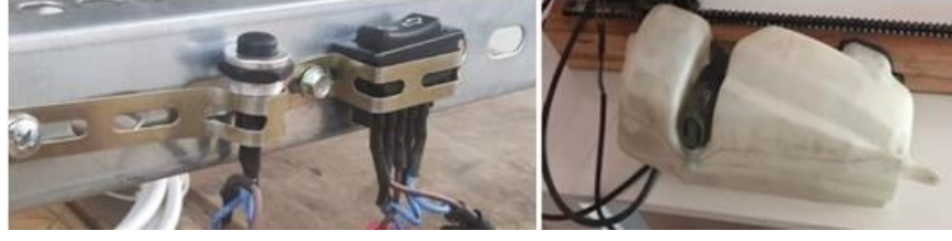
Şekil 3.11. İleri-geri anahtar ve düğmenin (butonun) metal gövdeye yerleşimi ve su tankı.
