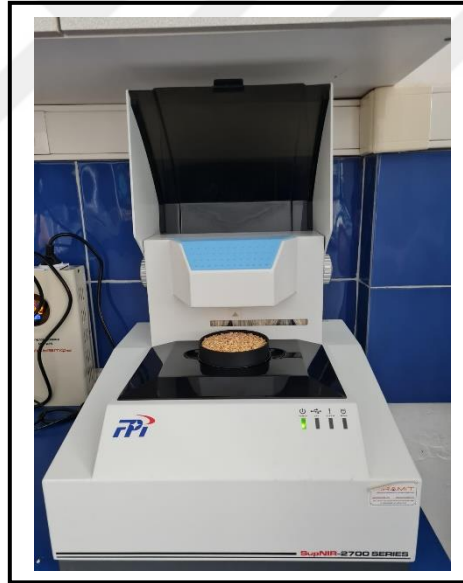
Şekil 3. 12. FPI-SupNIR-2700 cihazı ile protein ölçümlerinden bir görüntü.
