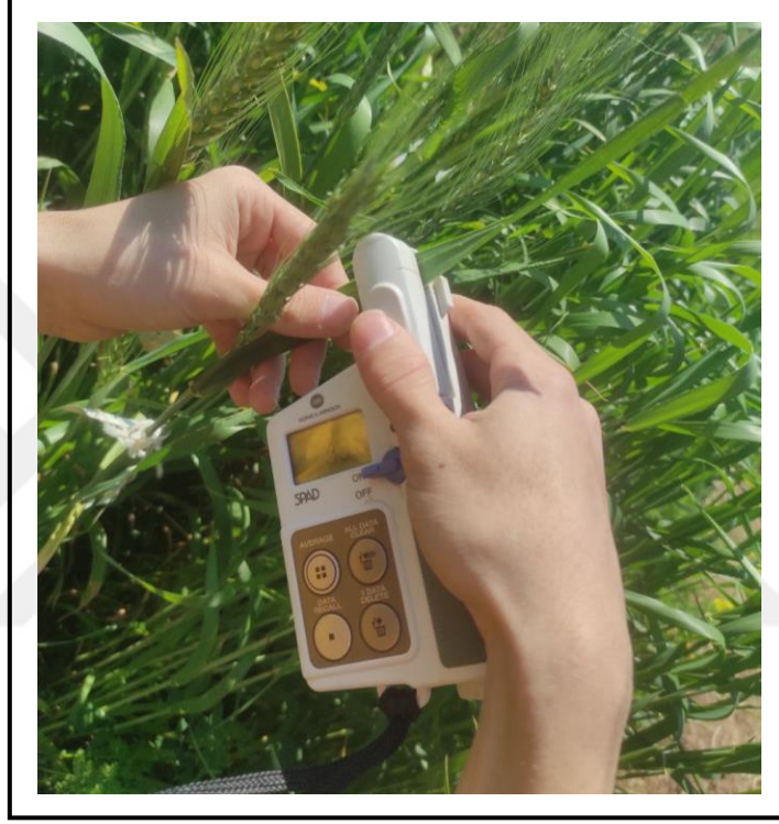
Şekil 3. 11. Konica Minolta SPAD 502 Plus klorofil ölçüm cihazı ile ölçüm yapılmasından bir görüntü.
