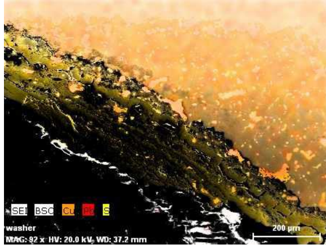
Şekil 3.16 Thrust washer parçası SEM görüntüsü.
