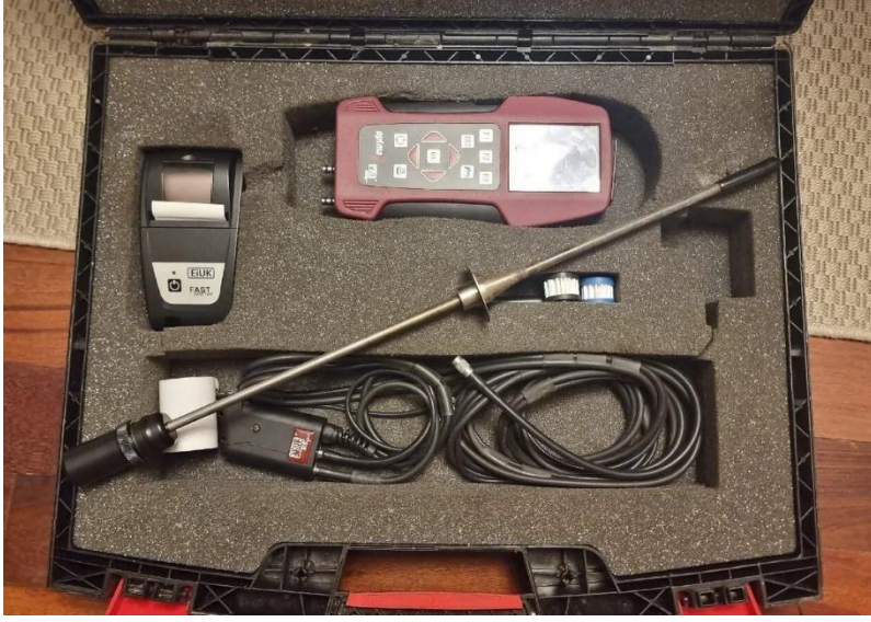
Şekil 2.4 Baca gazı ölçüm cihazı.
