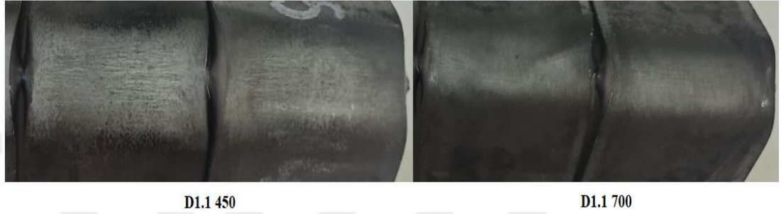
Şekil 5.30 : D kalitesinden üretilen D1.1 nolu bobinde sırasıyla; düşük (D1.1 450) ve yüksek (D1.1 700) sarılma sıcaklıklı bölgelerinden yapılan katlama testi sonrası yüzey görüntüleri.
