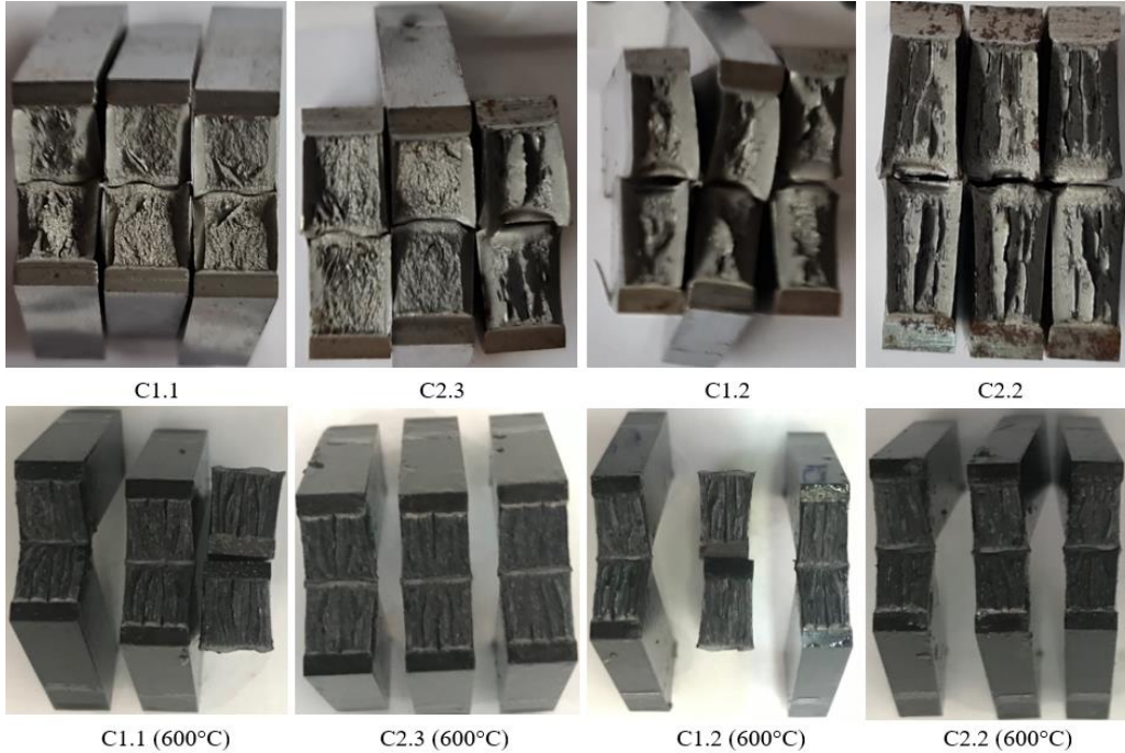
Şekil 5.26 : Borlu C kalitesinde ısıtılmamış ve 600°C de ısıtılmış numunelerinin -20°C de darbe testis sonrası kırık yüzey görüntüleri.
