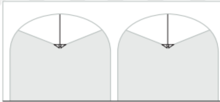
Şekil 4.26. Dolaylı (endirekt) aydınlatma kesit üzerinde gösterimi (Erco Lighting, 1992)
