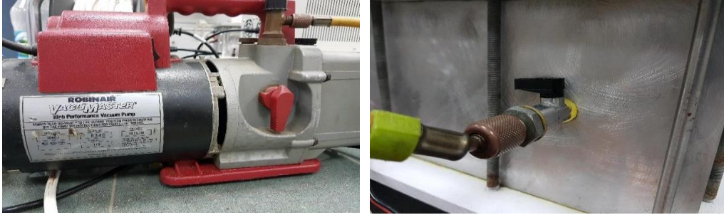
Şekil 3.17. Vakum sisteminin bağlantısı ve çalıştırılması.
