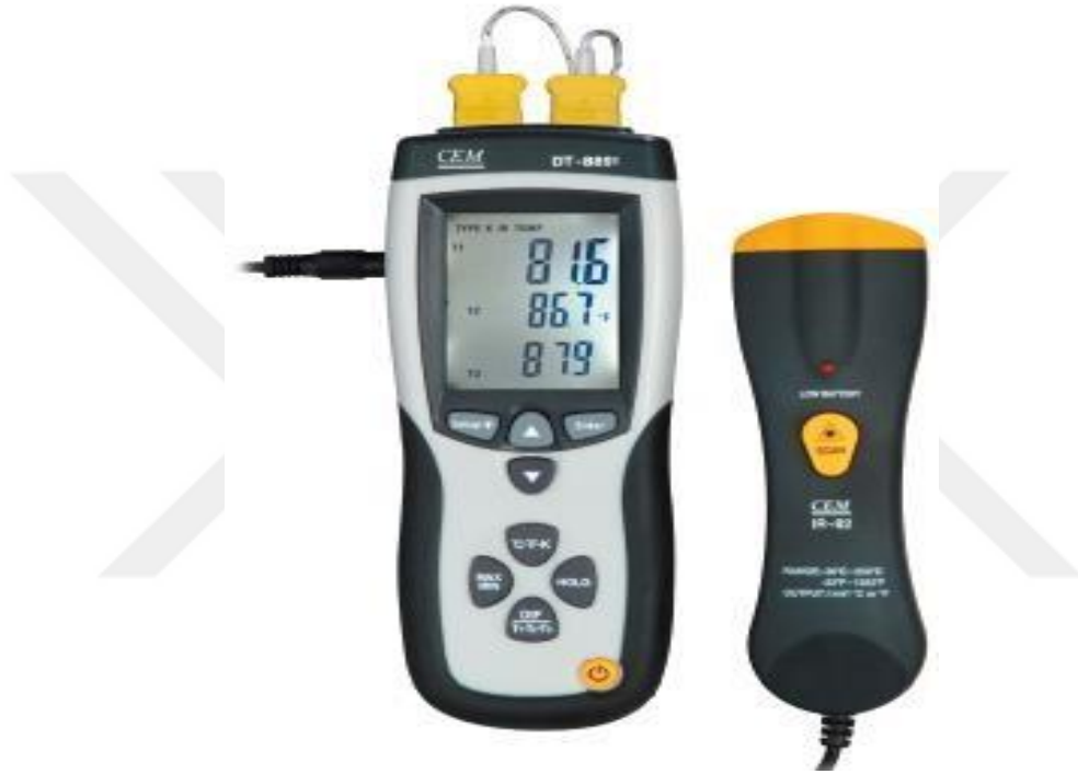
Şekil 3.8. DT 8891E K Tipi sıcaklık ölçüm cihazı.
