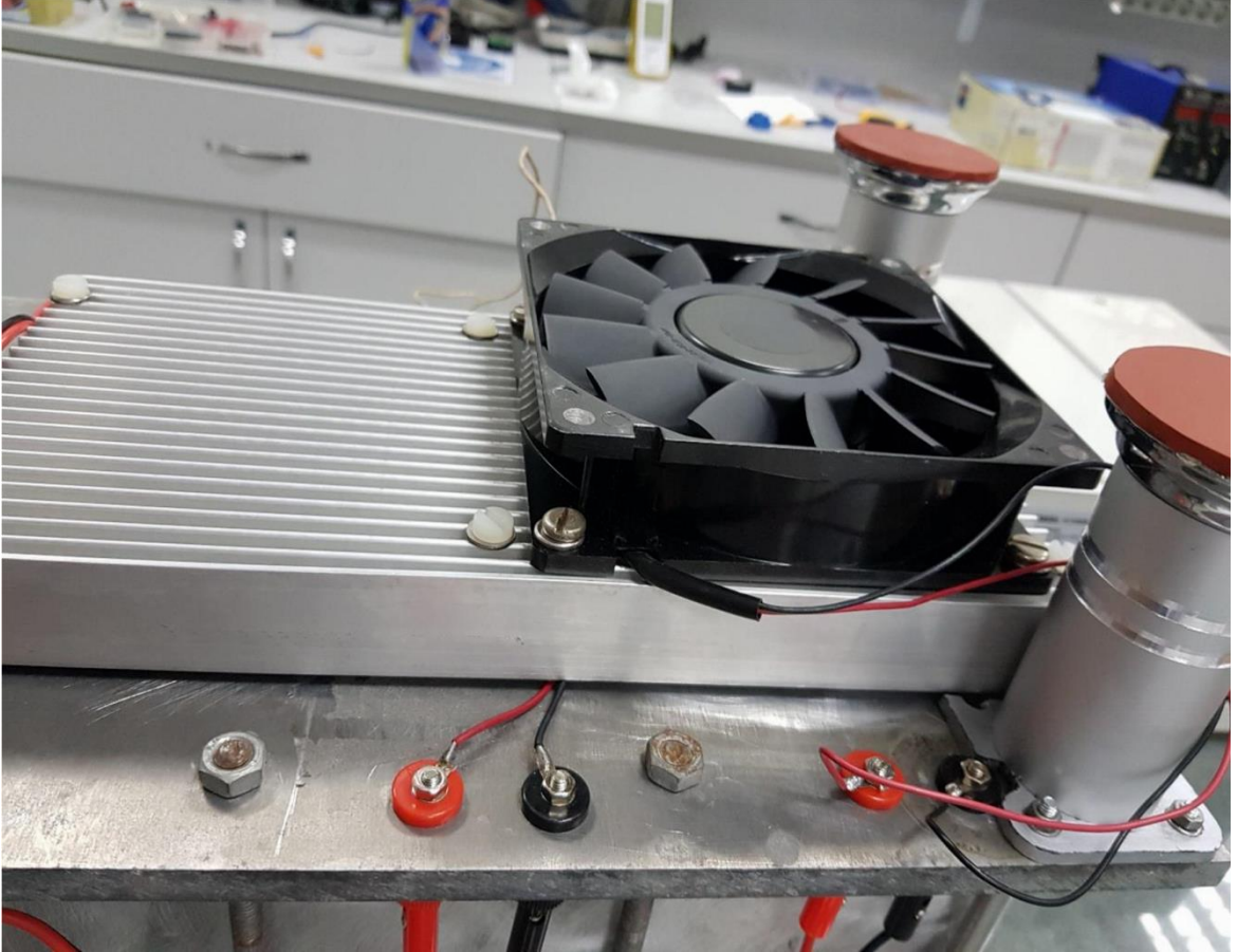
Şekil 3.11. Taban peltier, soğutucu petek, fan ve kablo bağlantıları.
