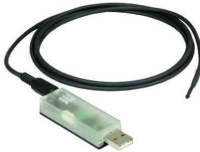
Şekil 3.7. Sıcaklık ve nem ölçü aleti (TSP-01 Thorlabs).
