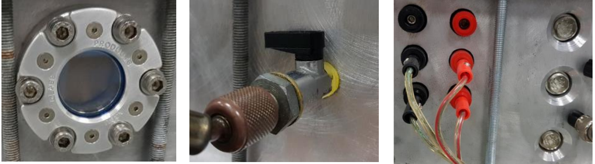
Şekil 3.2. Vakum penceresi bağlantısı, vakum pompası bağlantı vanası, elektrik ve veri bağlantı konnektörü.
