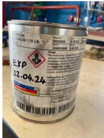
Görsel 4.7. ROYCO 44, uçak motoru bujileri, ateşleyicileri ve dişli bağlantı elemanları ve bağlantı parçalarında kullanılmak üzere geliştirilmiş tutukluk önleyici bileşen kontamine ambalajı (H7)
