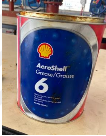
Görsel 4.12. AeroShell Grease 6, sürtünme önleyici olarak rulmanlar, dişli kutuları ve düz yataklarda kullanım için genel amaçlı bir gövde gresi (H4)
