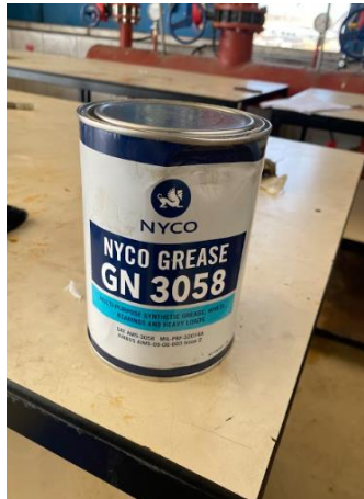
Görsel 4.10. NYCO GRES GN 3058, tuzlu ve nemli ortamlarda -54^{\circ}\text{C} ile +175^{\circ}\text{C} arasında değişen sıcaklık aralığında çalışmak üzere sentetik gres (H6)
