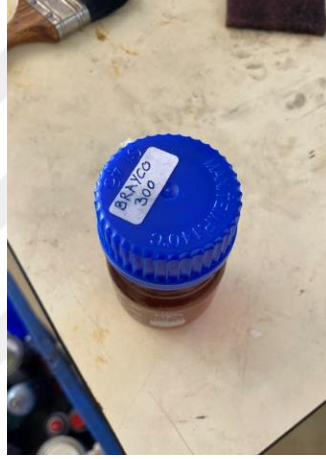
Görsel 4.9. Brayco 300 su ile yer değiştiren daldırma, çubuk, sprej veya fişkırtma tenekesi ile uygulanabilen yağlama yağı (H6)
