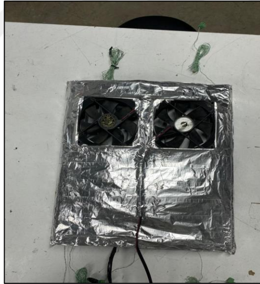
Şekil 5. 15.PV/T panel fan montajı.
