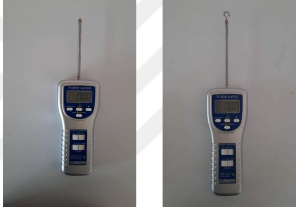
Şekil 3.11. Tane kabuk yırtılma (solda) ve tane saptan kopma kuvveti (sağda) ölçümü için kullanılan aparat
