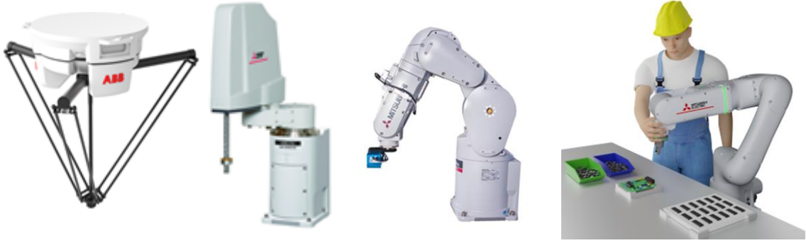
Şekil 1.1. Soldan sağa doğru Delta Robot, Scara Robot, Endüstriyel Robot ve Kolaboratif Robot
