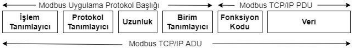
Şekil 3.15. MODBUS TCP/IP haberleşme yapısı
