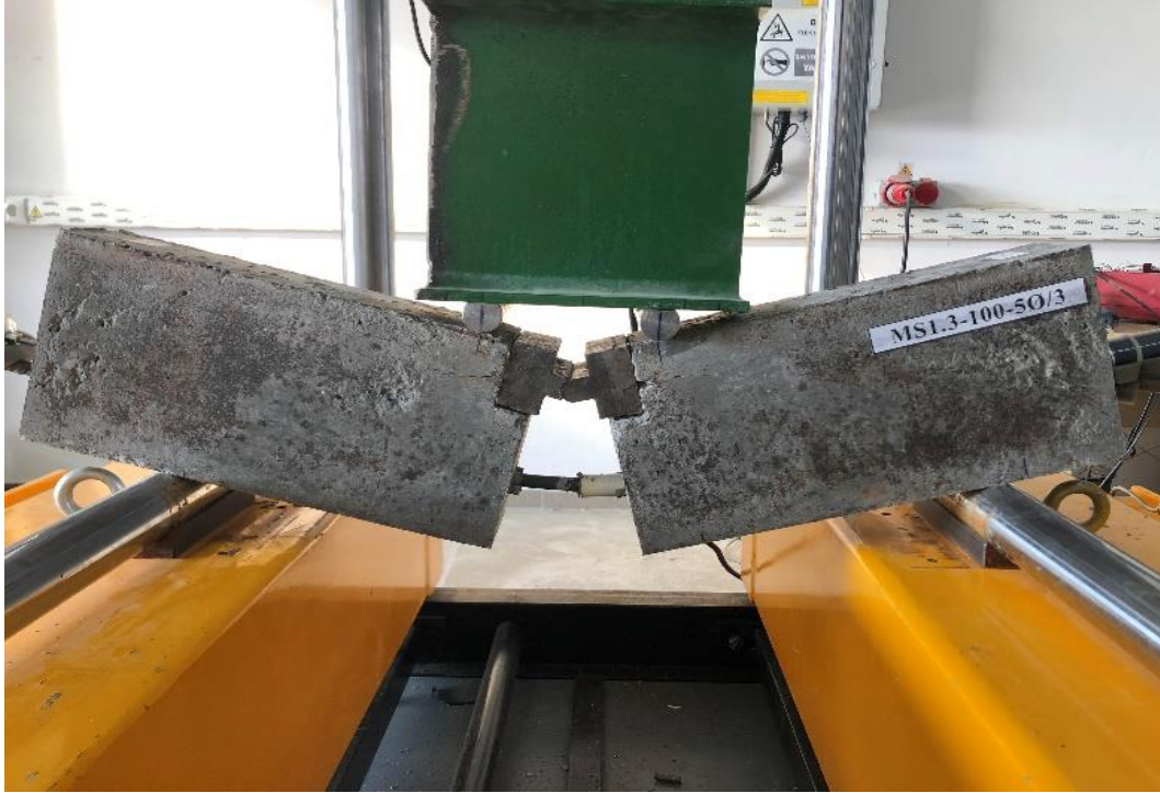
Şekil 5.16. BMK deneyi uygulanan bir kirişte meydana gelen sıyrılma
