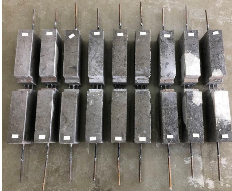
Şekil 5.12. Üretilen geopolimer kiriş numuneleri
