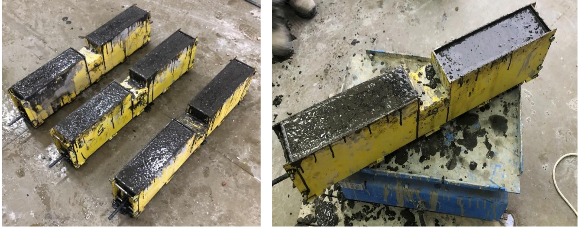
Şekil 5.10. Taze betonun kalıplara yerleştirilmesi ve masa tipi vibratörle sıkıştırılması
