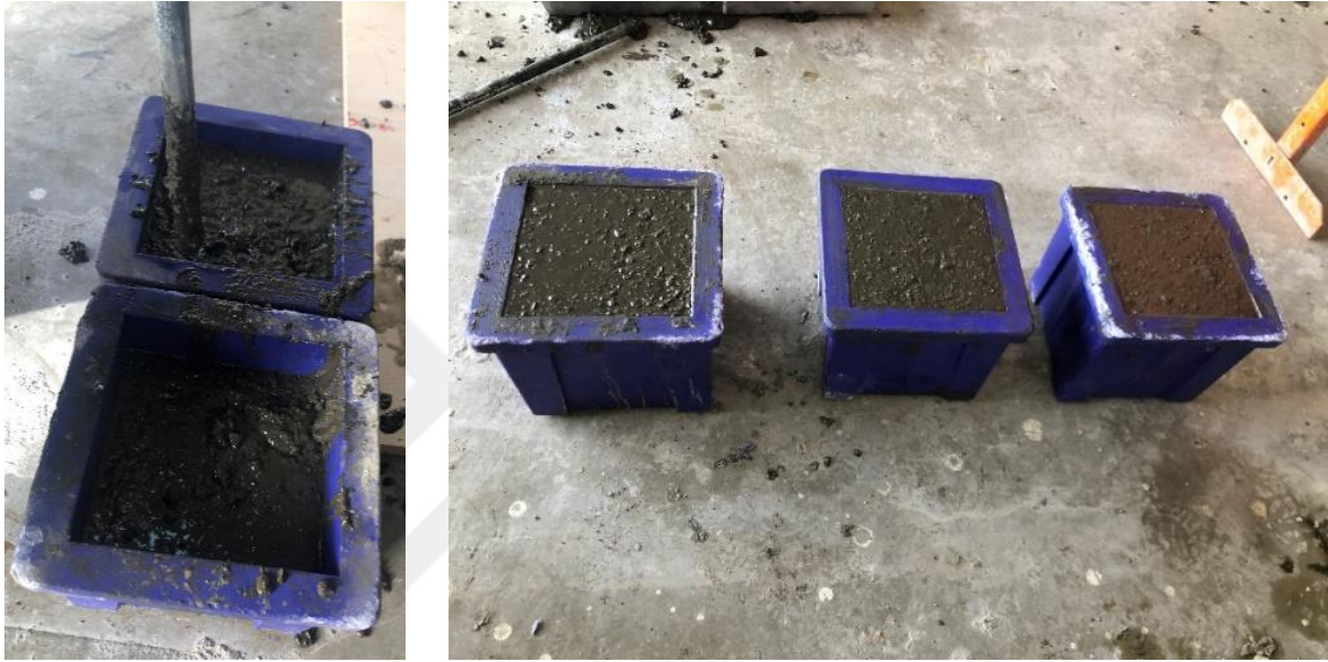
Şekil 5.4. Taze betonun kalıplara yerleştirilmesi
