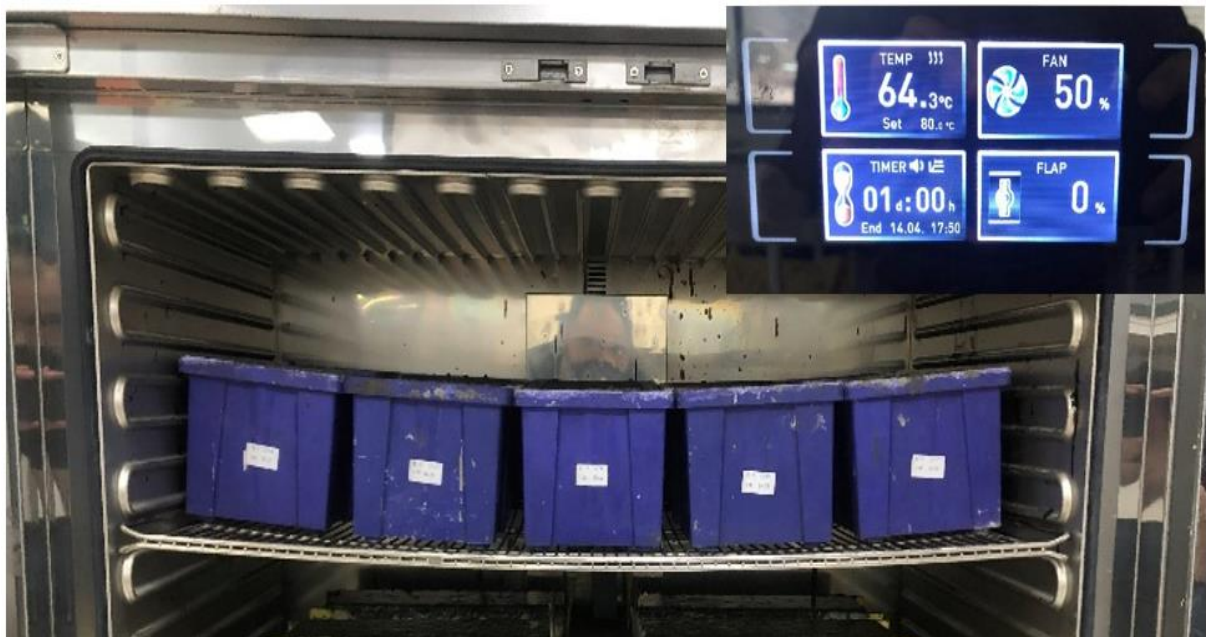
Şekil 5.5. Etüvde bekletilen geopolimer beton numuneleri ve etüve ait örnek kür şartları
