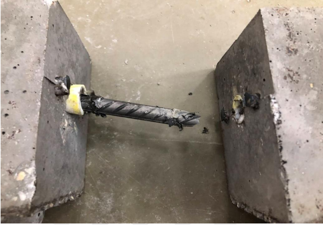
Şekil 5.17. BMK deneyi uygulanmış bir kirişte donatının kopması
