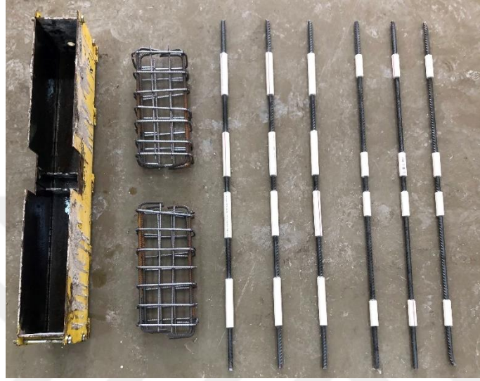
Şekil 5.9. Donatının kenetlenme boyunun sınırlandırılması
