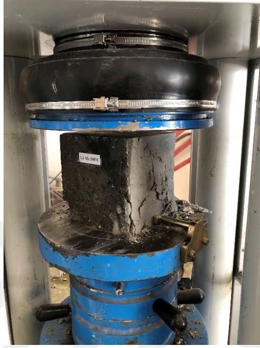
Şekil 5.6. Basınç dayanım testi uygulanmış bir geopolimer beton numunesi
