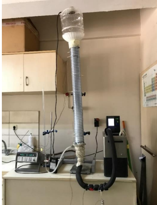
Şekil 3.9. Akışkan yatak deney düzeneği
