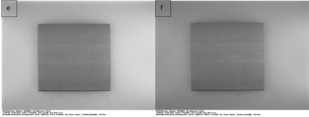
Şekil 43: (e) Koyu renkli kâğıt yüzeyin IR 645 nm dalga boyunda VSC cihazı altındaki görüntüsü (f) Koyu renkli kâğıt yüzeyin IR 925 nm dalga boyunda VSC cihazı altındaki görüntüsü.
