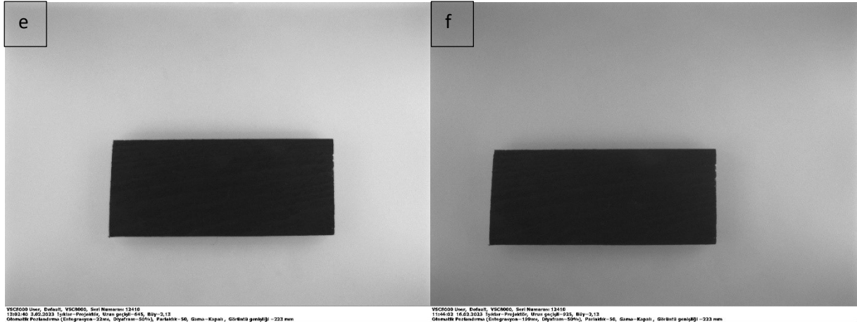
Şekil 39: (e) Koyu renkli ahşap yüzeyin IR 645 nm dalga boyunda VSC cihazı altındaki görüntüsü (f) Koyu renkli ahşap yüzeyin IR 925 nm dalga boyunda VSC cihazı altındaki görüntüsü.
