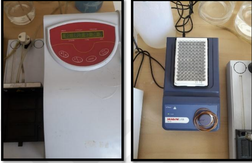
Şekil 3.4. Mikropilakanın yıkayıcıda yıkanması ve çalkalayıcıda inkübe edilmesi
